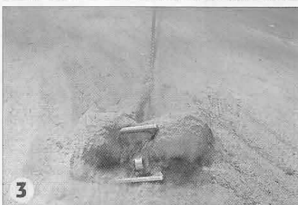
La FOB nous a semblé moins encline à se mettre sur le côté et a approché une tonne de Traction. Notez qu'en théorie, les ancres plates supportent un angle de traction plus élevé (comme sur l'image 4).
