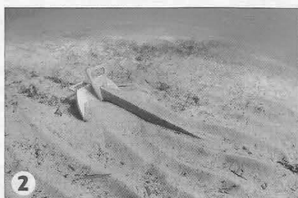
La traction commence plutôt bien pour la Britany qui s'enfonce correctement (1 et 2) dans le sable. Mais quand elle dérape, on devine à la motte de sable qu'elle déplace (3) qu'elle travaille en surface. Quand la traction se fait trop forte, elle se met sur la tranche et n'utilise plus qu'une de ses deux pointes (4).
