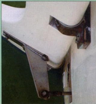
Une patte fixée au safran assure la transmission.
