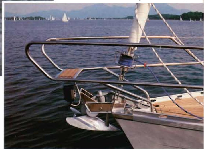
Geteilter Bugkorb mit Durchstieg. Divided bow pulpit with access.
