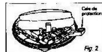
2) Ouvrir le radome en desserrant les 3 vis de fixation. Puis enlever la cale de transport. (fig. 2)
