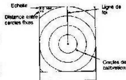
Pour sélectionner une échelle, appuyez sur la touche [RANGE], puis sur "+" pour incrémenter, ou "-" pour décrémente.
