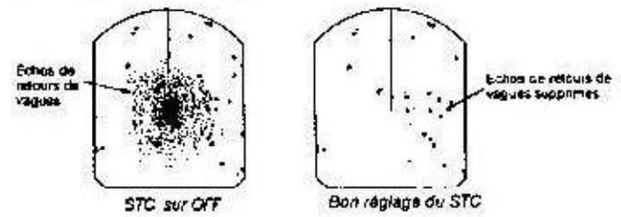
Le STC réduit l'amplification des échos sur les petites échelles (où le clapot est le plus important), et intensifie progressivement cette amplification au fur et à mesure que l'échelle augmente : l'amplification sera ainsi normale sur ces échelles où il n'y a pas de clapots. Cette commande est opérante jusqu'à environ 4 milles.
