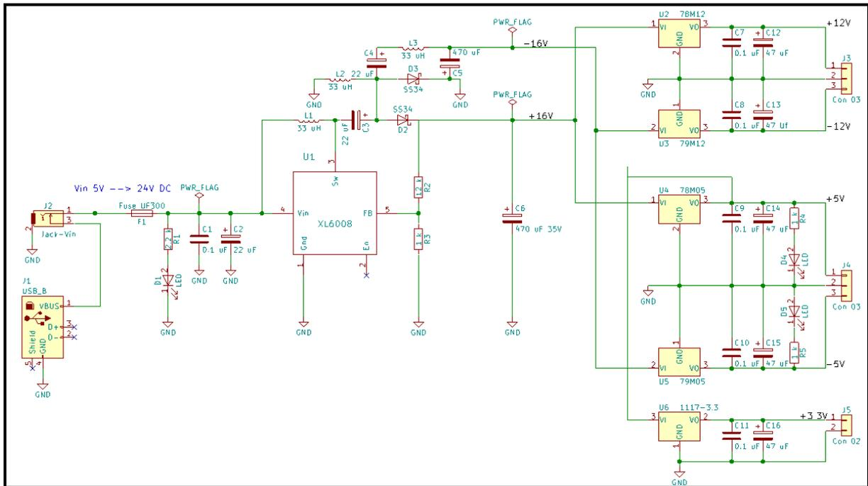
La partie gauche du schéma représente l'alimentation à découpage basée sur le circuit intégré XL6008 qui permet d'abaisser ou de relever la tension d'entrée à 16V et de générer une tension négative de -16V. La structure est basée sur une note d'application du circuit intégré XL6008.
