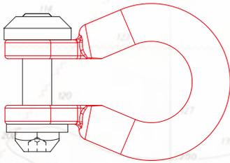
Cette liaison garantit la meilleure continuité de la résistance mécanique et l'absence de couple électrolytique. Son design unique sans arrêtes s'intègre parfaitement dans les daviers, offre un montage inviolable sécurisé et est traité anticorrosion.
