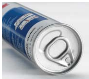
Cartouche aluminium avec protection et languette d'arrachage afin d'éviter que le mastic ne cuise dans la cartouche
