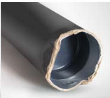
Les cartouches concurrentes sont en général plus sujettes à la déformation. Ceci peut entraîner un début de réaction de l'adhésif à l'humidité et plus de déchets si le produit doit être jeté.
