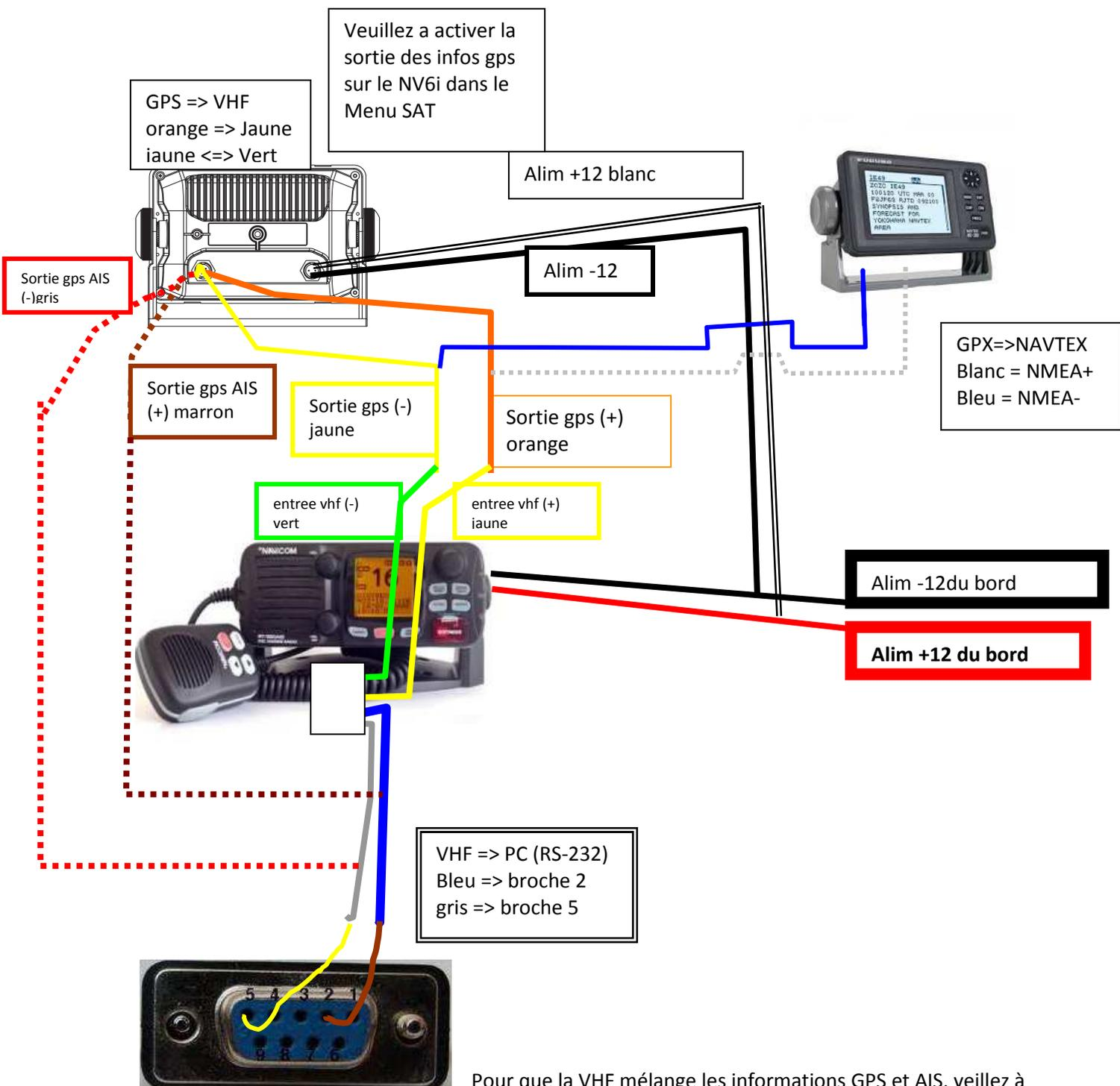
Pour que la VHF mélange les informations GPS et AIS, veuillez à activer la fonction REDIRECT GPS dans le menu de la VHF. La VHF nécessite quelques réglages, veuillez à indiquer un taux de transfert à 4800 bps, et une connexion en RS-232.
