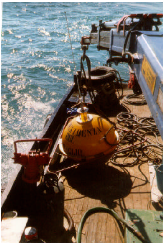
Fig. 1.3: Boa tipo waverider a traslazione.
