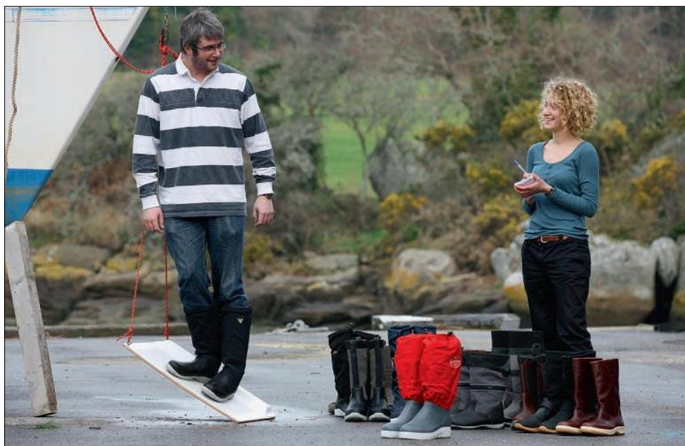
▲ Nous avons apprécié l'adhérence des différentes semelles à l'aide de ce dispositif réglable.
