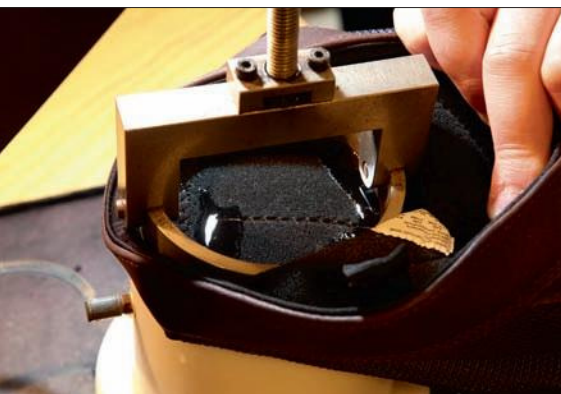
▲ Test d'imperméabilité peu concluant pour cette botte Sebago : l'eau passe par les coutures...
