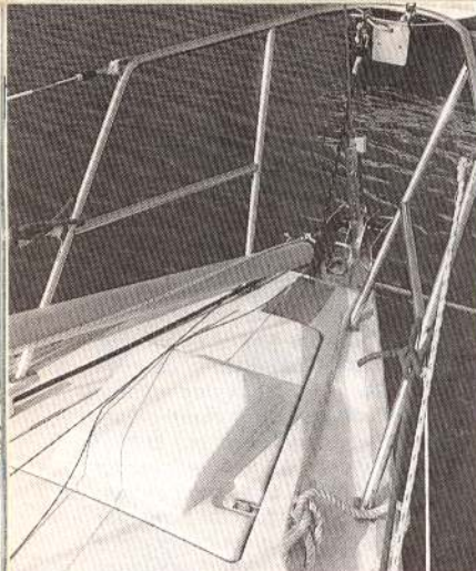
Le bossage prévu pour le guindeau encombre la plage avant du Feeling.
