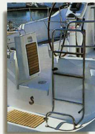
Folding helmsman's seat and rear door panel patented by Beneteau Siège barreur et porte arrière basculante / Brevet Bénéteau
