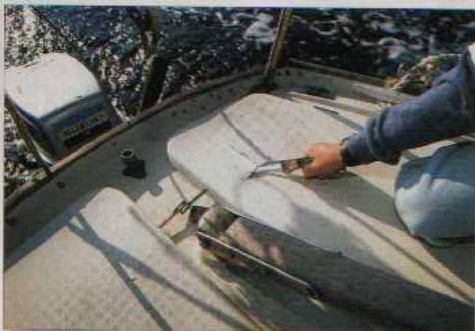
Le capot bâbord du grand coffre arrière est bien malade, la mousse a pris l'eau par une déchirure dans le « plastique ».
