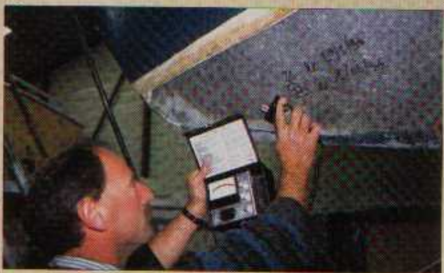
Depuis notre étape n°3, traitant du pelage de la carène pour la soigner de sa maladie de l'osmose, Ariane sèche. Grâce à un appareil Sovereign, nous en contrôlons régulièrement l'évolution. En novembre dernier, nous étions à la graduation 25, nous en sommes à 18 au 1 er avril et il faudra attendre 5 pour attaquer le traitement...
