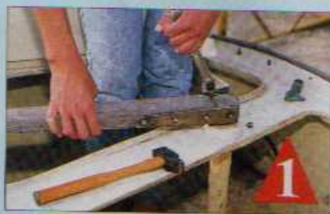
1 La barre est solidaire du carré par un axe de 8 mm, muni d'un écrou à chaque extrémité. Le démontage semble facile !
