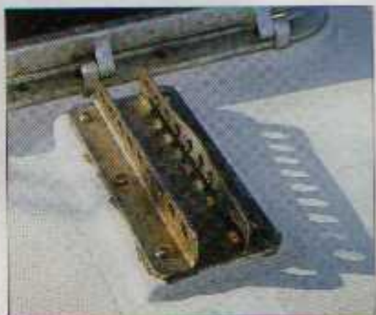
Le pied de mât (tordu !) est simplement tenu par six vis à bois.
