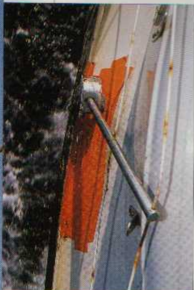
La plupart des chandeliers ont arraché leur support sur le pont, provoquant des entrées d'eau à l'intérieur...
