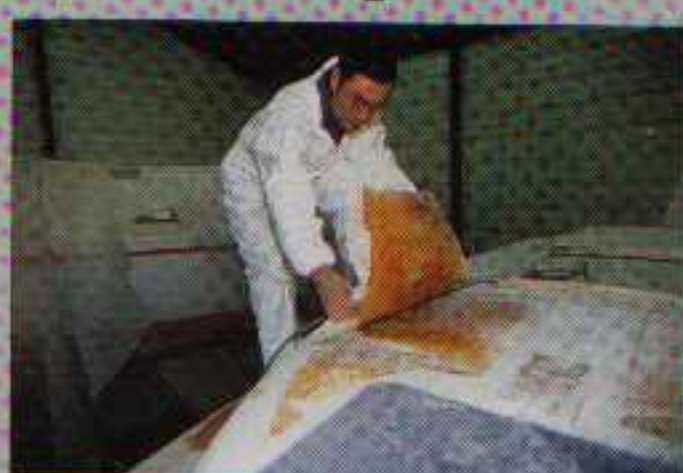
La peau extérieure du sandwich, en fibre de verre/résine polyester, est retirée.
