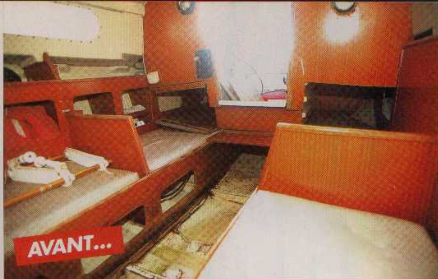
Notez la forme du contre-moule solidaire de la coque pour le positionnement de la menuiserie.
