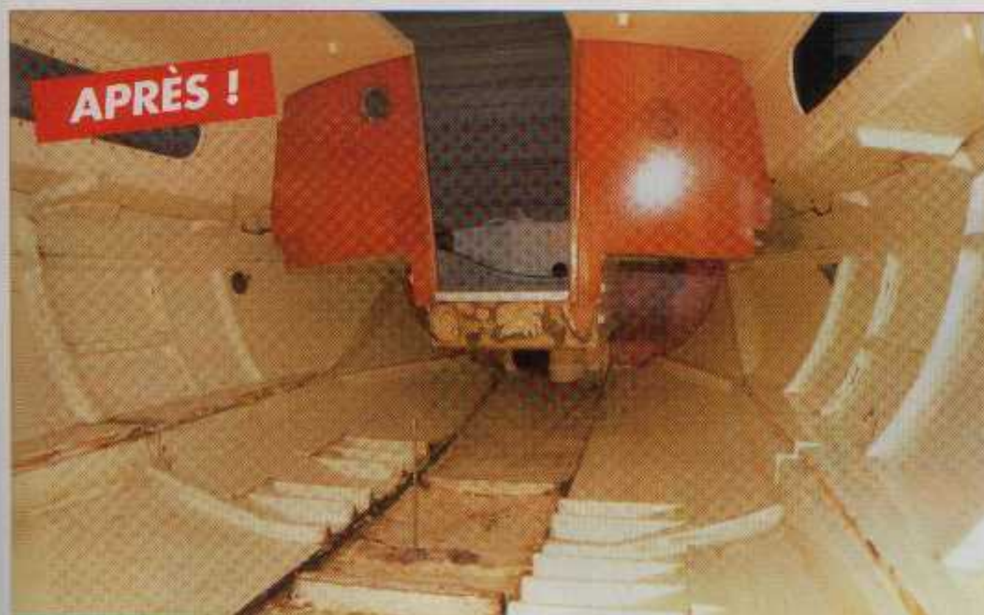
Notez la forme du contre-moule solidaire de la coque pour le positionnement de la menuiserie.
