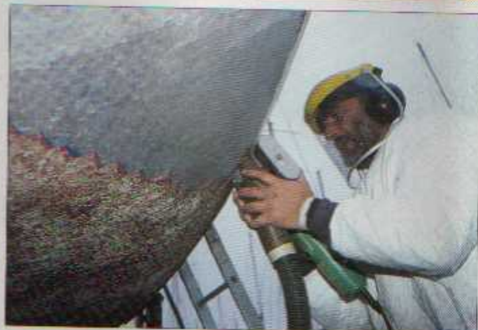
Notre spécialiste a raboté la coque de 2 mm en épaisseur.
