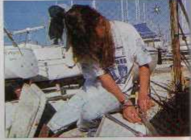
Une simple clé de 10 et un tournevis pour démonter les listons en teck.
