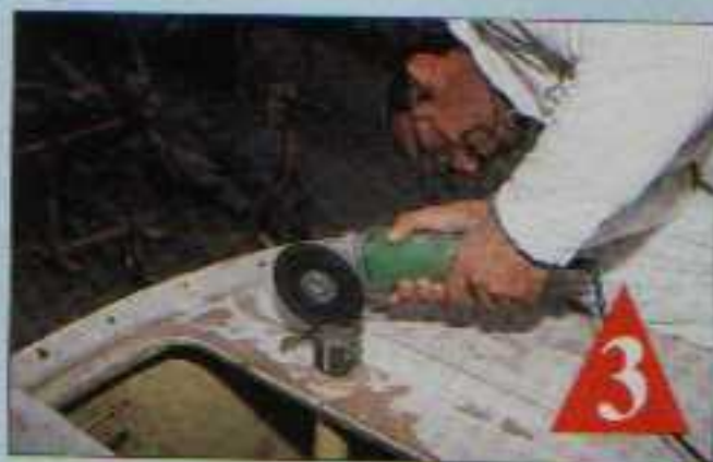
3 Après avoir tout tenté pour sortir l'axe, il faut se résoudre à découper le carré avec une meuleuse, sans toucher à la mèche.
