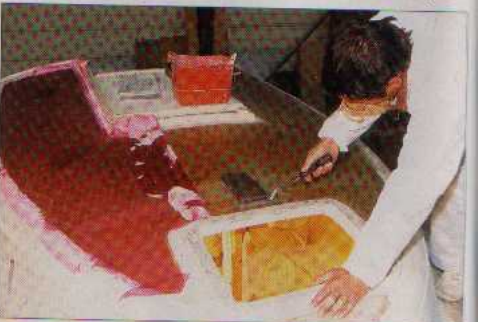
Le débullage au rouleau débulleur de toutes les couches est indispensable pour que les couches soient vraiment planes.
