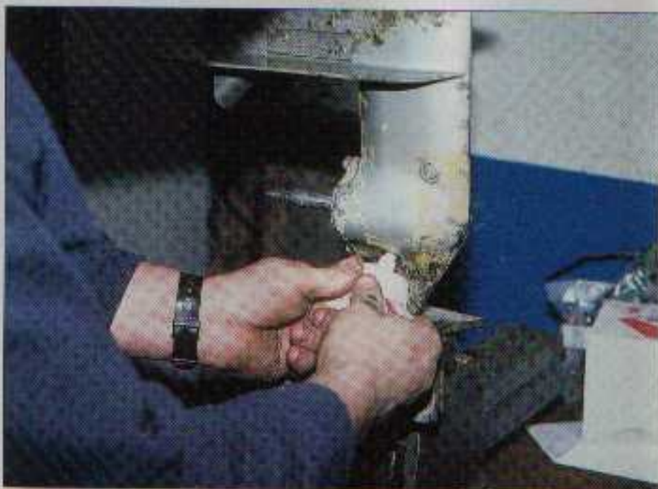
C'est par le boulon du bas qu'il faut remplir l'embase d'huile.
