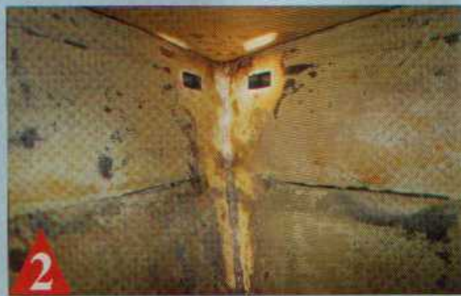
2 La coque est débarrassée des tissus malades et les reprises de strat' sont poncées. Il ne reste vraiment pas grand-chose.
