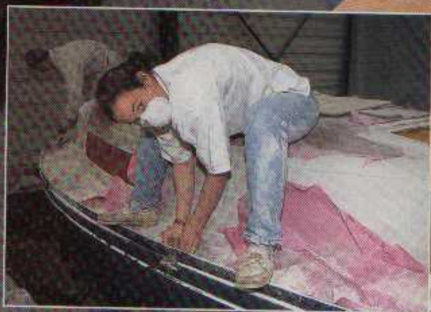
Dans les recoins, la ponceuse ne passe pas et il faut alors finir le ponçage à la main...
