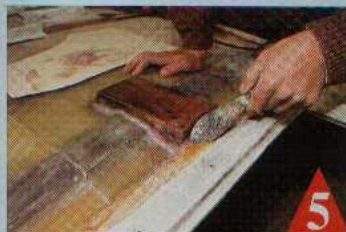
Sur cette nouvelle peau intérieure consolidée, le collage du support de mât est possible.
