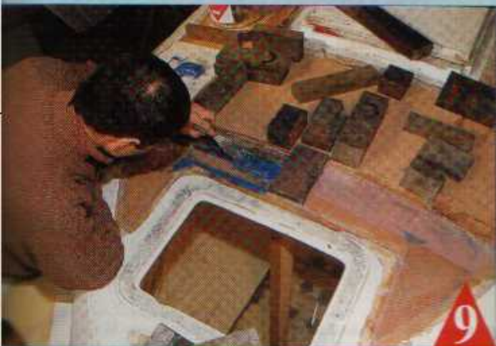
9 Une fois les grands (et les petits !) panneaux de mousse posés, on recouvre le barrot avec de la « choucroute ».
