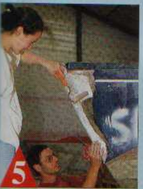
5 Un mat de verre et quatre tissus bibiais sont stratifiés.
