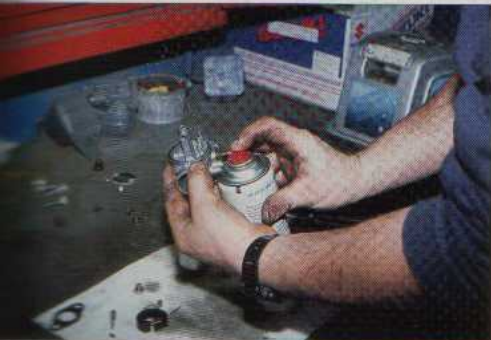
On pulvérise du « Nettoyant carburateur » dans les conduits.
