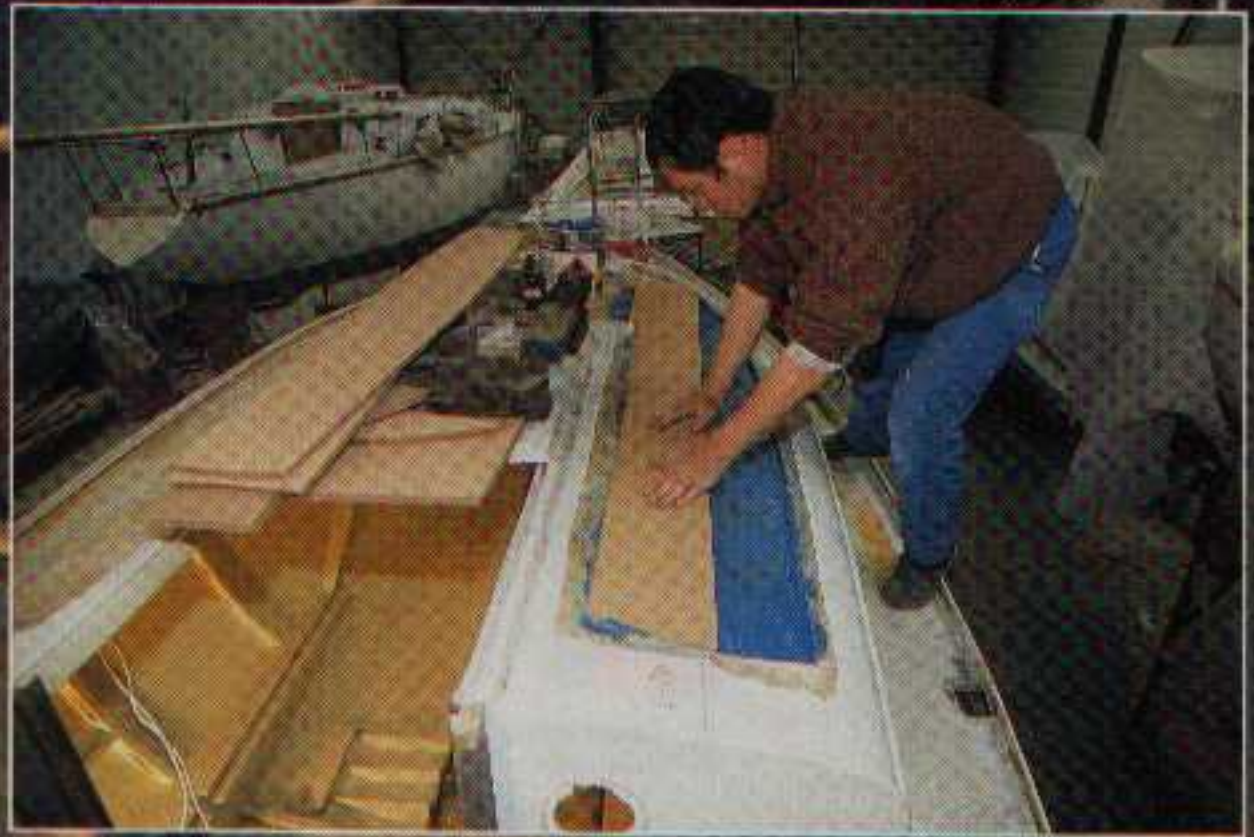
Une fois les panneaux découpés au cutter, la mise en place de la mousse doit s'effectuer rapidement car la « colle » (en bleu sur les photos), de la résine polyester armée se catalyse rapidement.
