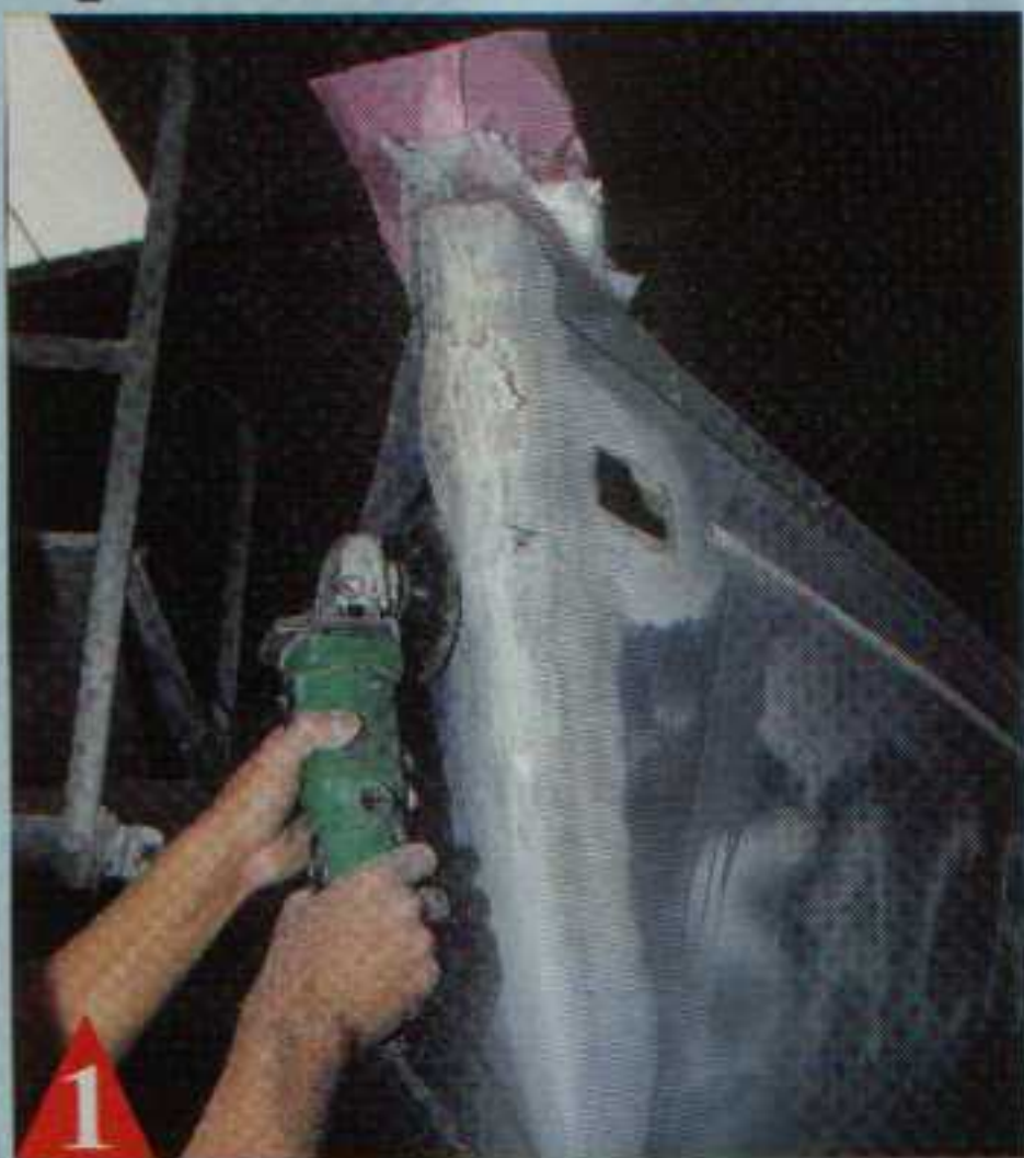
1 Une fois la strat' intérieure, qui sert de moule, bien durcie, on peut enlever tous les tissus endommagés par l'extérieur.
