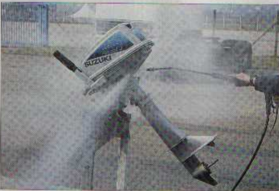
Avant la peinture, un bon coup de nettoyeur haute pression.
