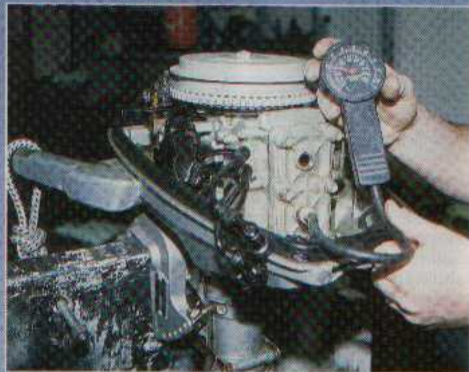
Un manomètre mesure la compression de chaque cylindre.
