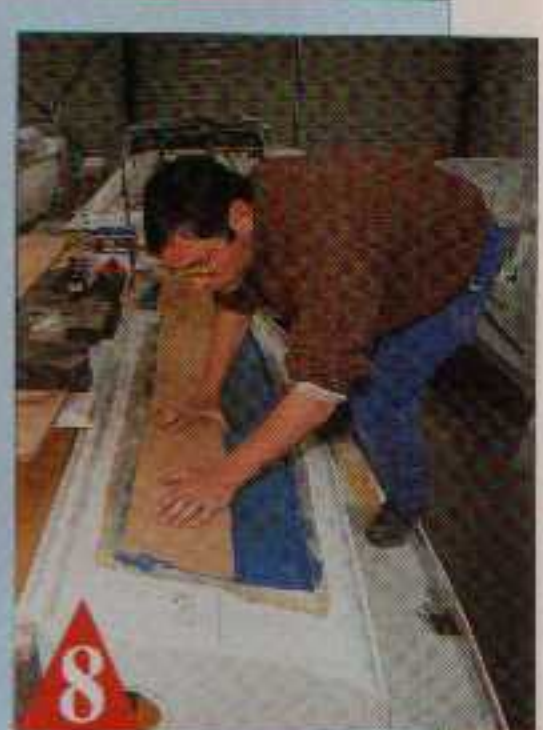
Toute la difficulté consiste à faire glisser les panneaux sous les rebords de reprise de stratification pour remplir tout l'espace.
