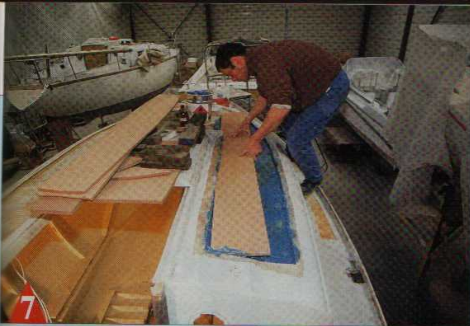
Toute la difficulté consiste à faire glisser les panneaux sous les rebords de reprise de stratification pour remplir tout l'espace.
