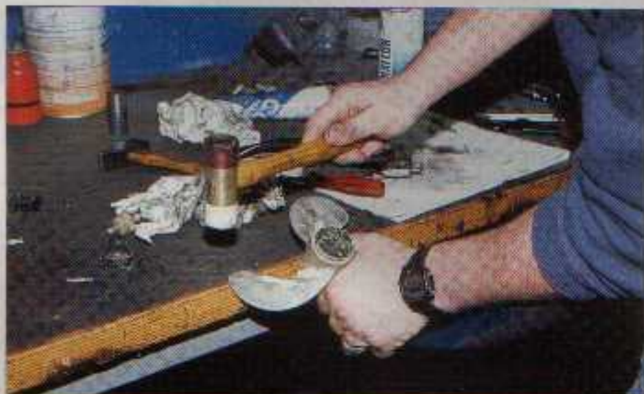
L'hélice est détordue sur l'établi avec un gros maillet.
