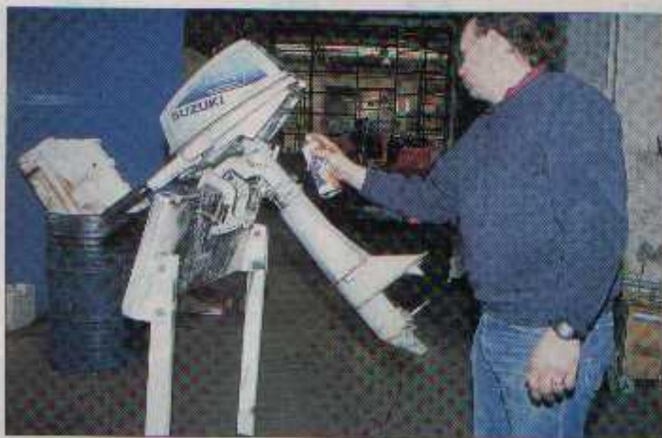
Le moteur est repeint à la bombe, par couches très fines.
