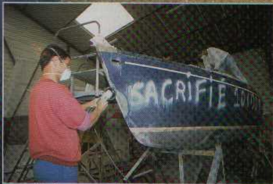
Le ponçage de l'étrave au lapidaire sera effectué après son moulage par l'intérieur, afin de conserver sa forme initiale.
