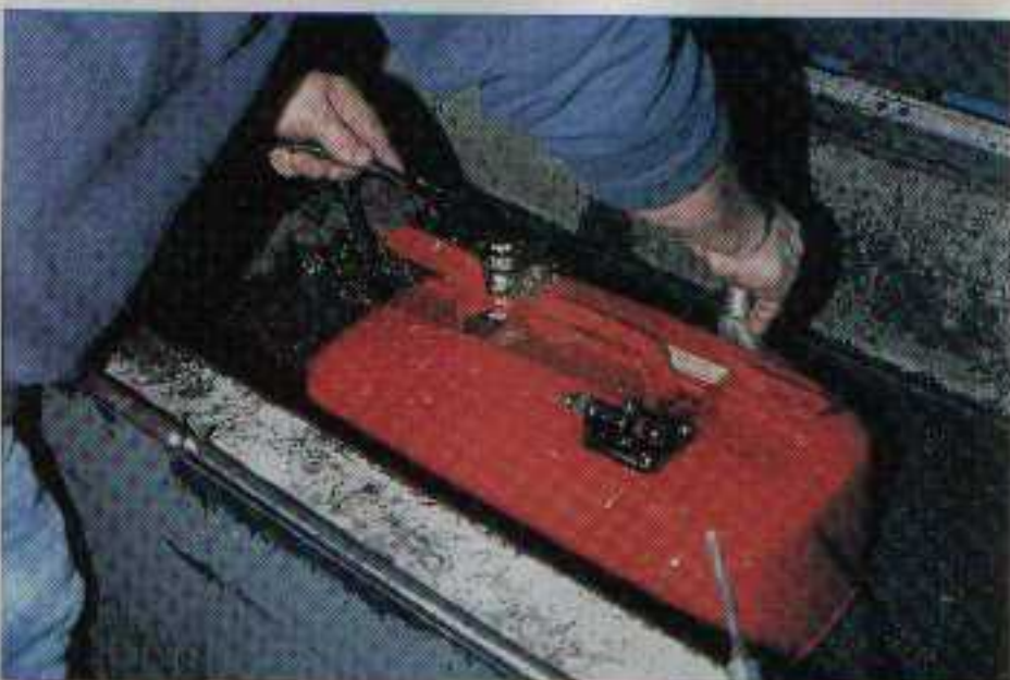
La nourrice est dégraissée à l'essence et la rouille grattée.
