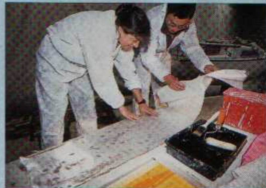
La nouvelle mousse en place, la prochaine étape consistera à la recouvrir de tissu de verre et de résine polyester.
