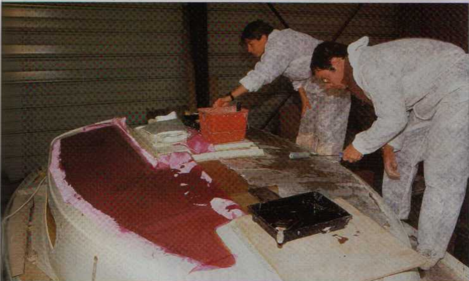
La partie tribord du rouf (à gauche sur la photo) a reçu son tissu d'arrachage qui assurera une finition parfaite à la stratification.
