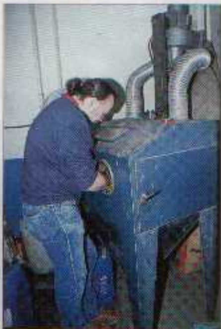
Les petites pièces sont passées à la sableuse.
