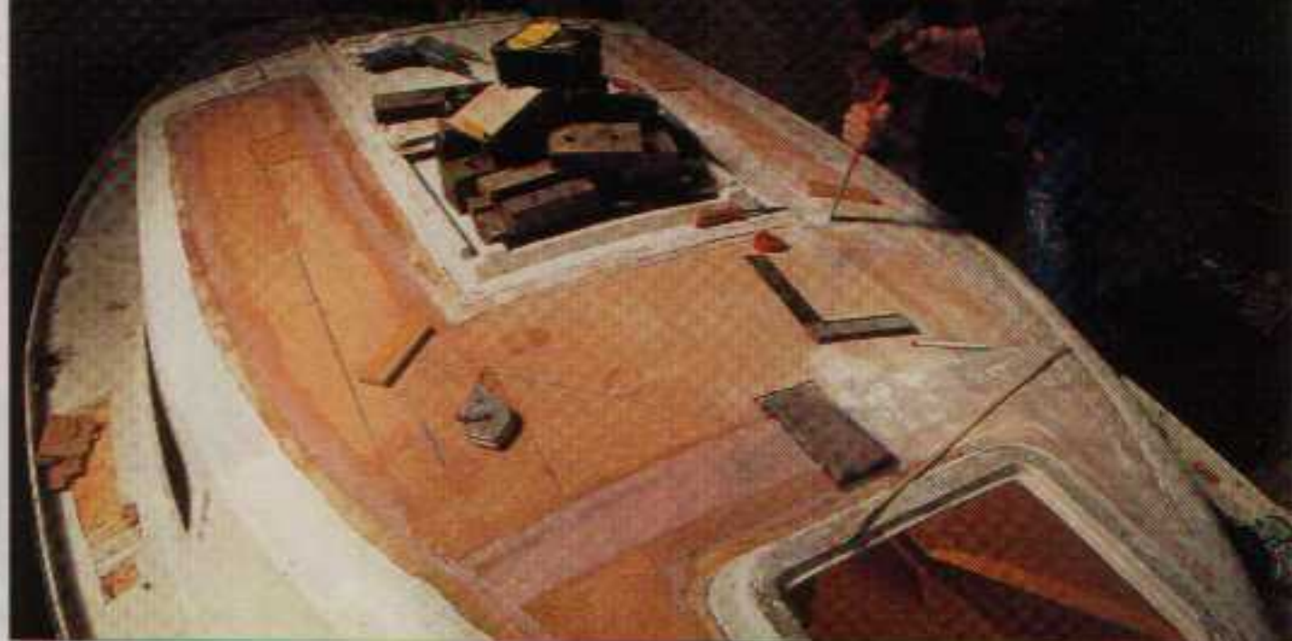
Nous avons profité de cette étape pour intégrer à la mousse des inserts en teck qui permettront de poser sur le pont des poulies de renvoi de drisses et des taquets coinçeurs.
