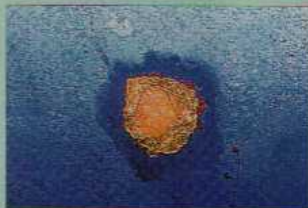
On le voit bien sur cette photo une bulle d'osmose ouverte : les tissus de fibre de verre sont attaqués et par voie de conséquence, la solidité de la coque est mise en cause.
