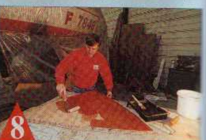
8 Il faut stratifier l'intérieur de la baille qui sera difficilement accessible une fois posée.
