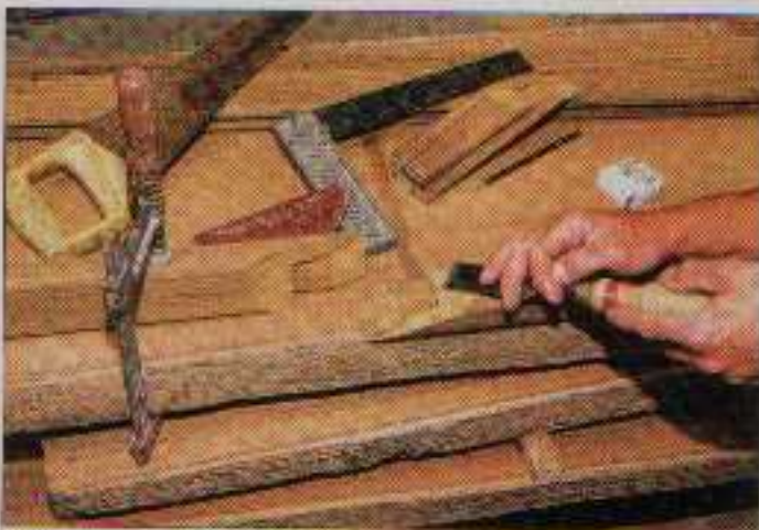
Pour araser parfaitement les deux parties du scarf, le ciseau à bois est l'outil idéal.
