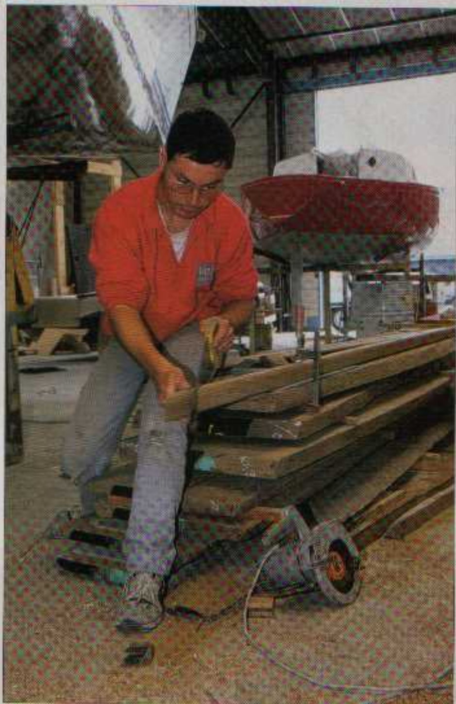
Les scarfs des listons sont coupés à l'égoïne puis collés à plat en prenant soin de tenir les deux pièces avec des serre-joints.
