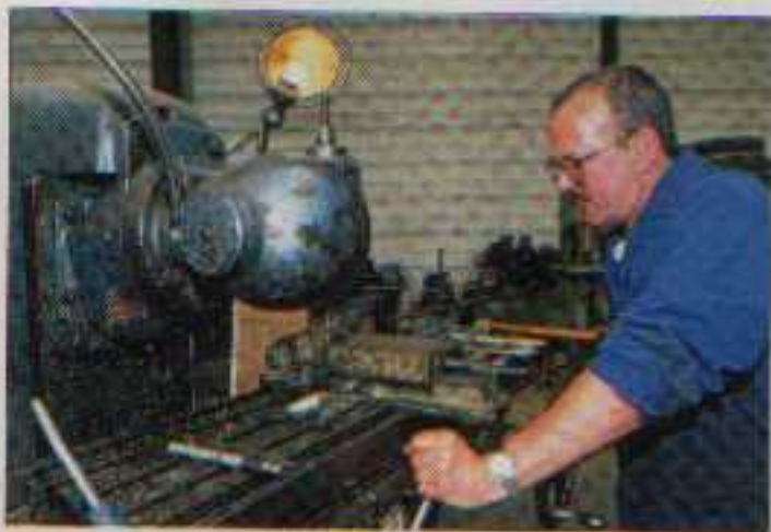
Il faut compter deux bonnes heures sur une fraiseuse pour réaliser un carré de barre en cupro-aluminium (bronze marin), en partant d'un bloc, comme ici chez AMB à La Rochelle.
