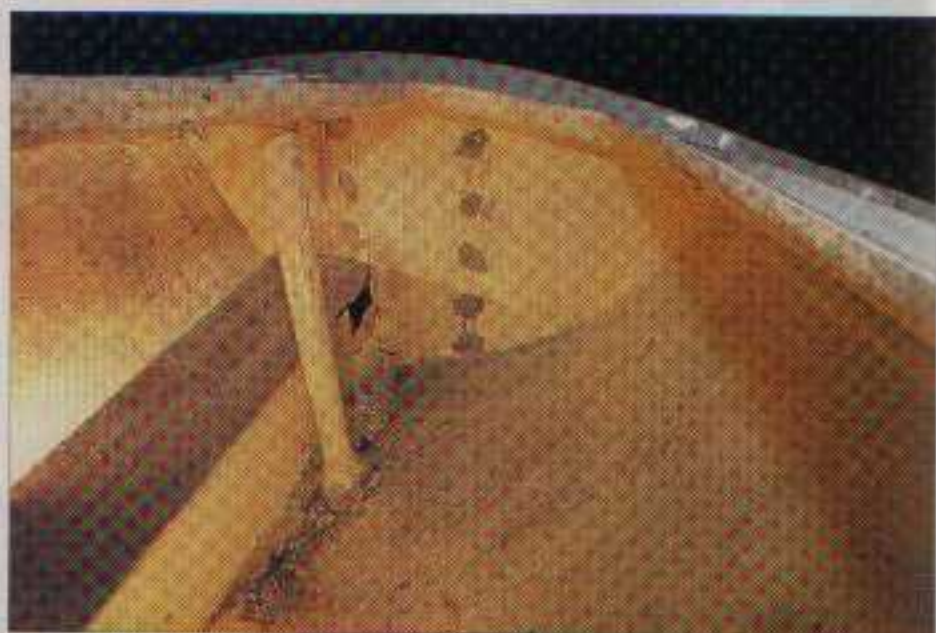
Dans le fond du coffre, des reprises de stratification s'imposaient pour reboucher certains trous, comme sur le caisson qui permet de glisser une godille ou le tangon à l'intérieur.
