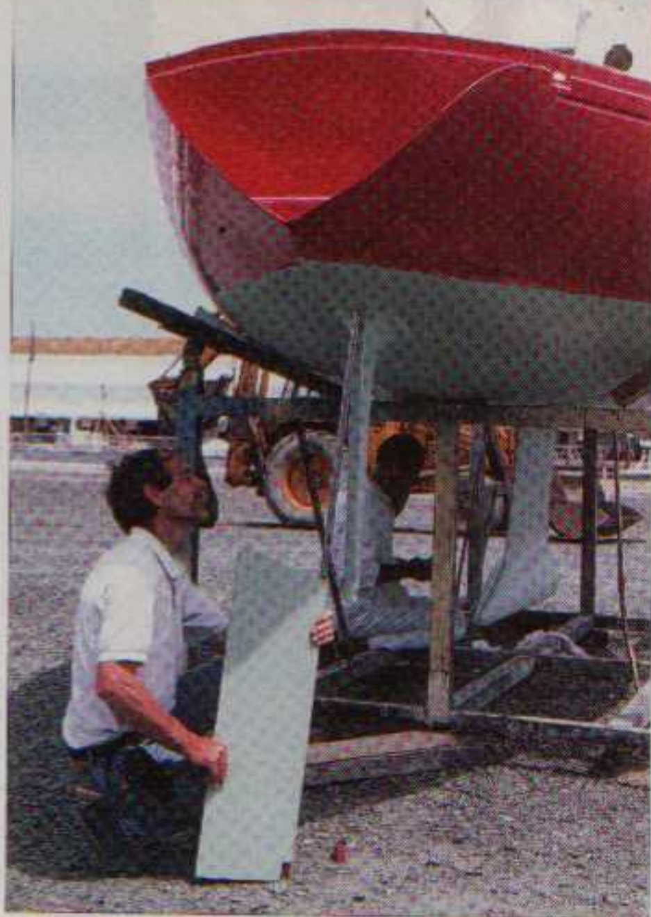
Il faut que le bateau soit légèrement surélevé afin d'avoir la hauteur pour introduire la mèche dans le tube de jaumière.
