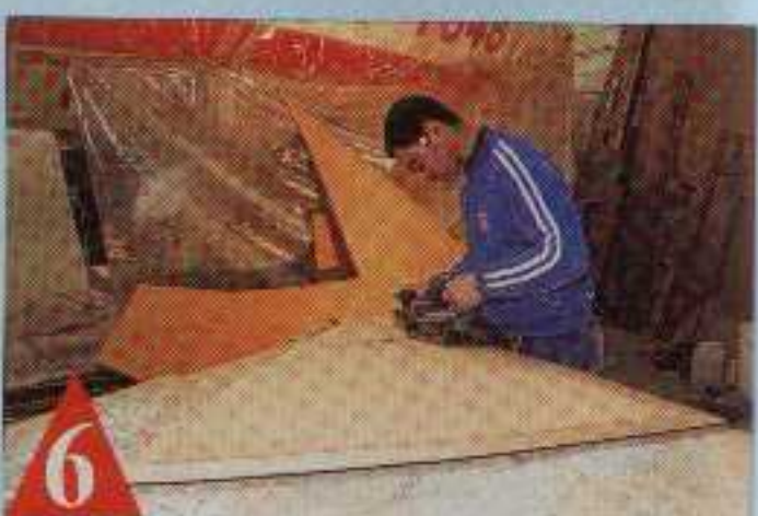
6 Après un premier ajustage sur le bateau, les chants sont chanfreinés au rabot électrique.
