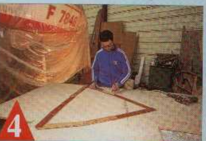
4 À l'aide de cette ébauche, retracez la forme directement sur le contreplaqué de 18 mm.
