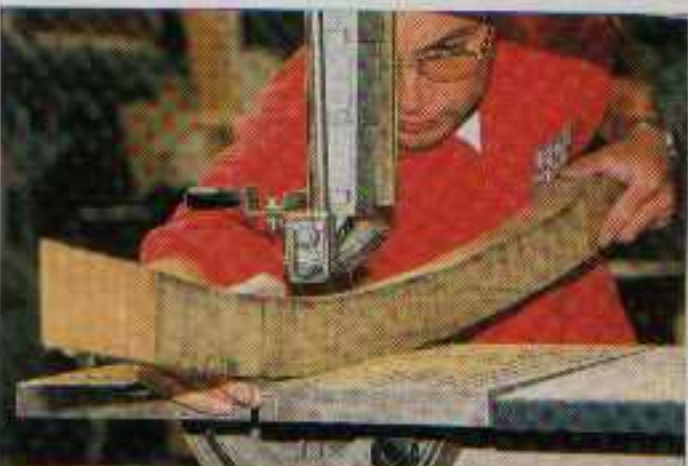
La partie arrière du liston est coupée à la forme et non cintrée, à cause de la courbe du tableau.
