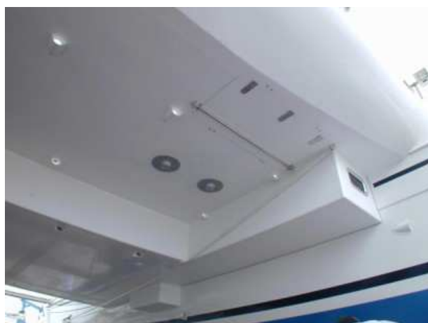
18 et 19 - Emplacement du radeau (6 places) sur un catamaran Outremer 45 (le coffre de l'ACCROCH'COEUR était similaire mais adapté à un radeau 8 places et longitudinal)
