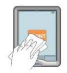
7 Vérifiez qu'il n'y a pas d'eau à l'intérieur en regardant à travers la partie transparente. Si oui, vérifiez les bords, la position des joints, sécher l'intérieur et répéter le test
