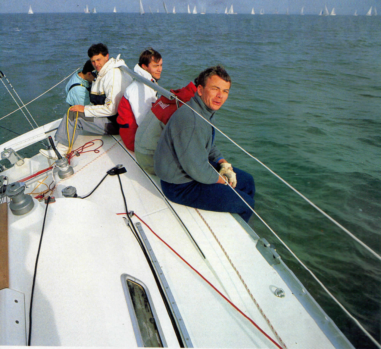
ie d'un confortable cale-pied intégré dans le polyester. Le réglage du pataras revient au barreur. Les winches de drisse sont fixés sur le roof.
