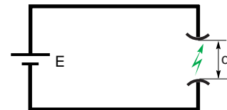
Fig. 2 : l'arc électrique et l'influence du champ E/d .
