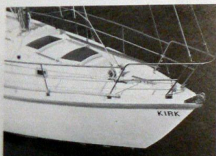
La plage avant est ceinturée par des filières en tube inox qui prolongent le balcon jusqu'à l'arrière.
