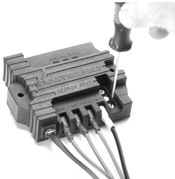
Figure 14 : Réglage des potentiomètres
