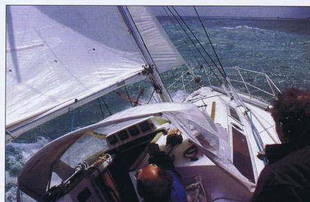
Le panneau de descente fuit légèrement par mauvais temps, d'où l'intérêt de la capote qui protège aussi les veilles dans le cockpit.
