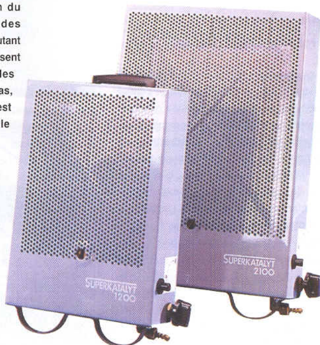
MIEUX ADAPTÉS AUX USAGES TEMPORAIRES, LES APPAREILS À CATALYSE DÉGAGENT UNE HUMIDITÉ IMPORTANTE QU'IL CONVIENT D'ÉVACUER GRÂCE À UNE BONNE AÉRATION.
