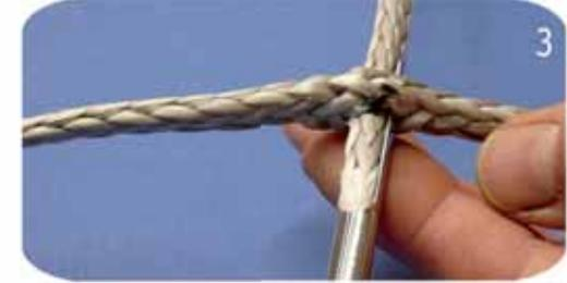
Réalisez la boucle à l'aide d'une aiguille.
