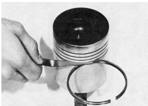
Figure 18. Mesure du jeu segment-gorge
