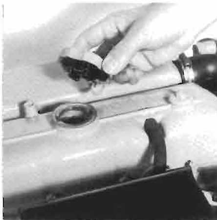
La tapa de relleno de aceite. Tappo di riempimento.
