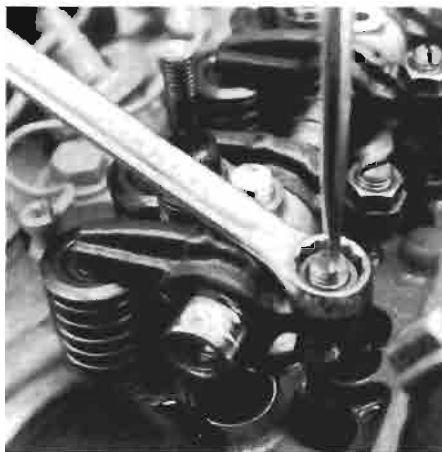
Einstellen des Ventilspiels. Réglage du jeu des soupapes.
