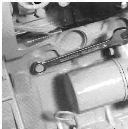
Entfernen der Ablasschrauben. Dépose de bouchons de purge.
