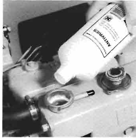
Relleno del sistema de refrigeración. Aggiungere liquido nel sistema di raffreddamento.
