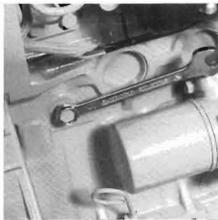
Verwijderen aftappluggen. Drainplugs removal.
