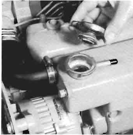
Prüfen des Kühlflüssigkeitsstandes. Contrôle du niveau du liquide de refroidissement.
