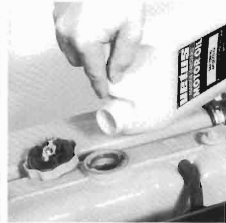
Hervullen met olie. Refilling with oil.
