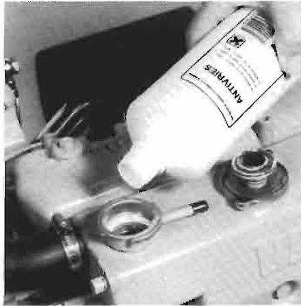
Füllen des Kühlsystems. Remplissage du système de refroidissement.
