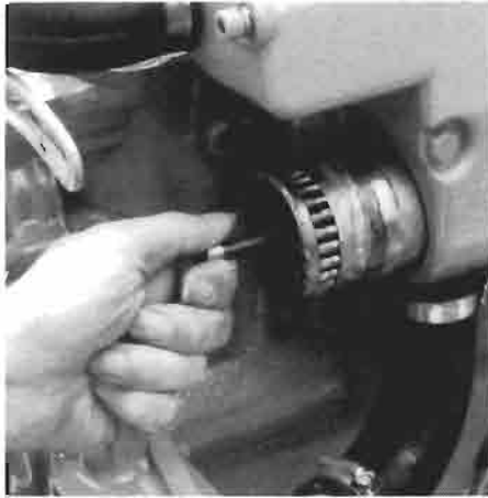
Sacar el intercambiador de calor. Rimozione dello scambiatore di calore.
