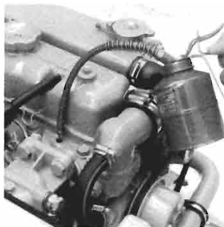
Inyectar aceite. Iniezione d'olio.
