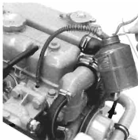
Öl einspritzen. Injection d'huile.
