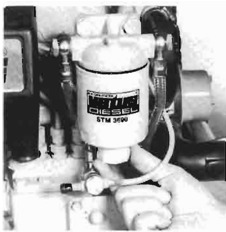
Desaguar el separador de agua. Scarico del separatore dell'acqua.
