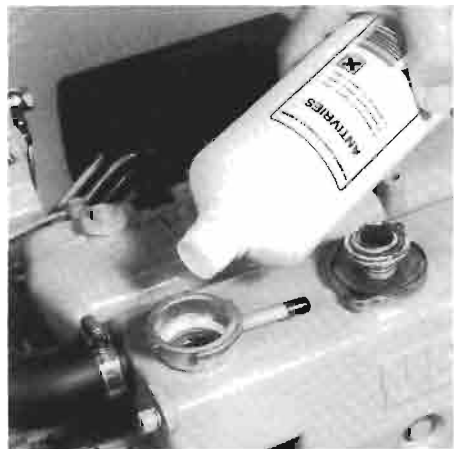
Rellenar el sistema de refrigeración. Riempimento del sistema di raffreddamento.
