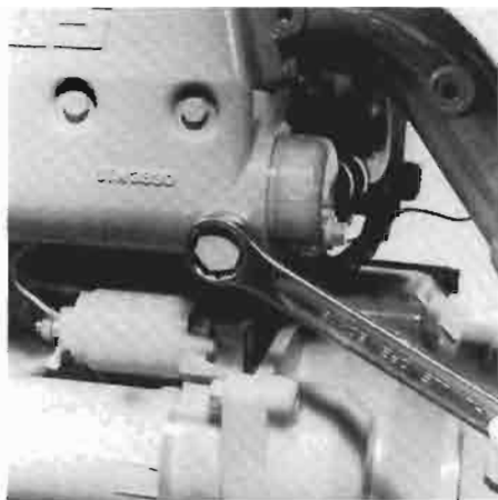
Retirar el tapón de desagüe. Rimozione del tappo di scarico.
