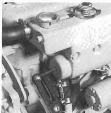
Verwijderen centrale bouten uit de keerdeksels. Removal of central bolts out of the end covers.
