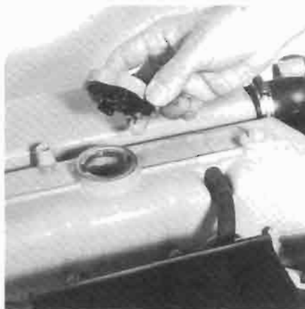
Der Öleinfüllstutzen. Le bouchon de remplissage d'huile.
