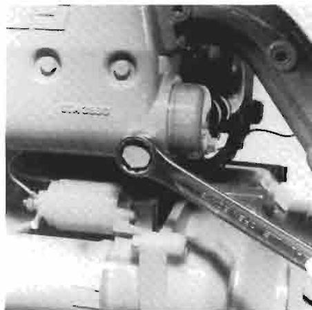
Entfernen der Ablasschrauben. Dépose de bouchons de purge.
