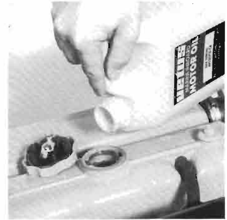
Öl nachfüllen. Remplissage d'huile.
