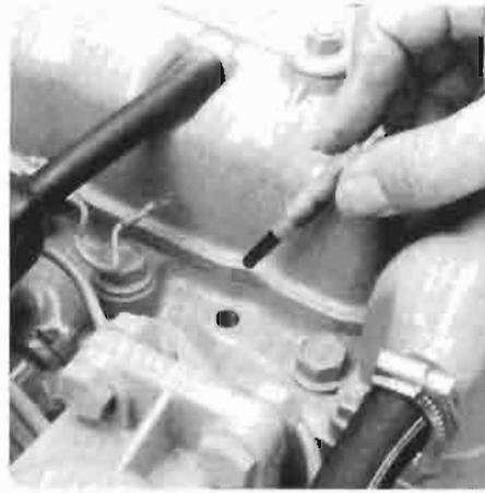
Gloeipluggen verwijderen. Removal of glow plugs.
