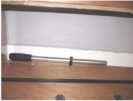
Groupe hydraulique / Brinquebale de secours (Relevage manuel)
