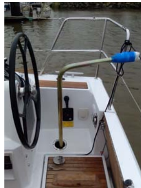
Barre franche de secours - en place
