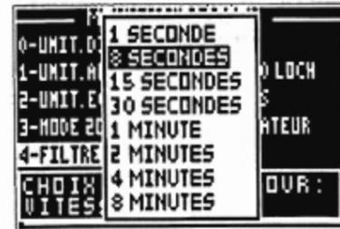
Conseil : le filtrage ou lissage permet d'obtenir une vitesse plus stable. Pour un mobile rapide (exemple : voiture) utiliser une constante courte et pour un véhicule lent (exemple : bateau) utiliser une constante longue.
