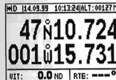
Note : la lettre D s'affiche en haut à gauche dans les écrans de fonction lorsque le FX312 calcule sa position en mode différentiel. L'indication de précision ECP prend automatiquement en compte la précision du mode différentiel.
