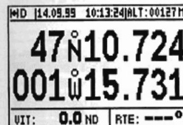
Note 1 : la lettre D s'affiche en haut à gauche dans les écrans de fonction lorsque le FX412 calcule sa position en mode différentiel. L'indication de précision ECP prend automatiquement en compte la précision du mode différentiel.
