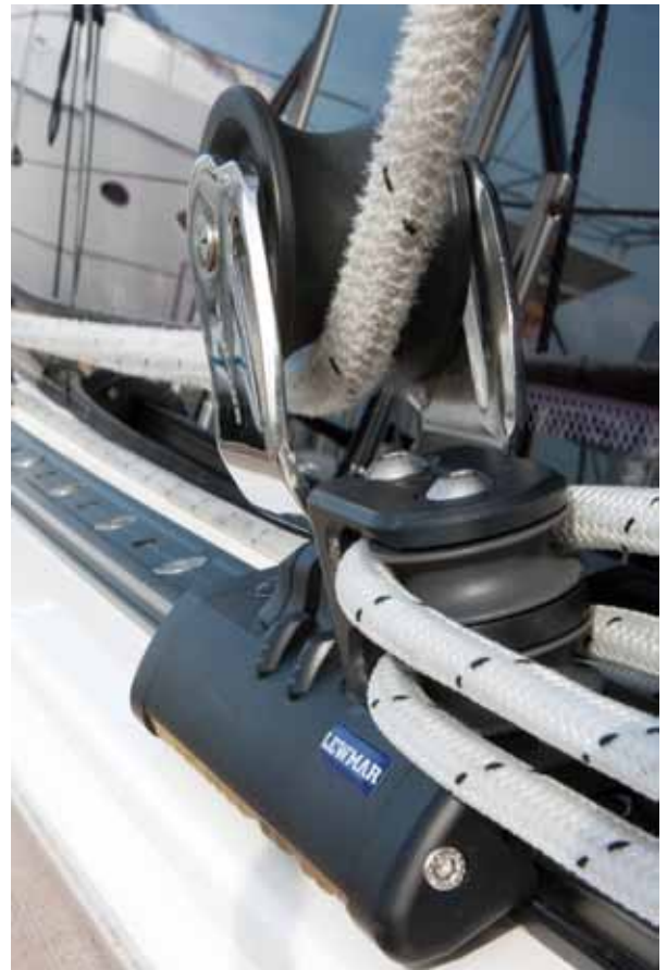
Détail de coupelle de cardan NTR Taille 2
