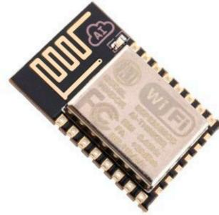
Le cœur de ce système est l'ESP8266. C'est un microcontrôleur qui a par construction des fonctions pré-programmées pour les liaisons WiFi.
