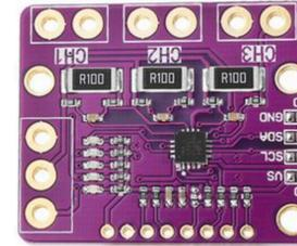
Le INA3221 a une interface numérique du type I2C (un bus en fait). Cette interface est très pratique puisqu'on peut mettre plein d'objets de ce type sur le même bus, chaque objet ayant sa propre adresse. C'est grâce à cette fonction qu'un jour j'ajouterai un module I2C qui lira les tension/courant d'éventuels panneaux solaires.
