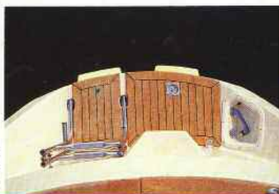
Solide Beschläge für Schot- und Leinenführung Solid fittings for sheet and line guides
