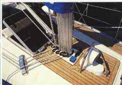
Großdimensionierte Lüftungshutze Generously sized dorade-vent
