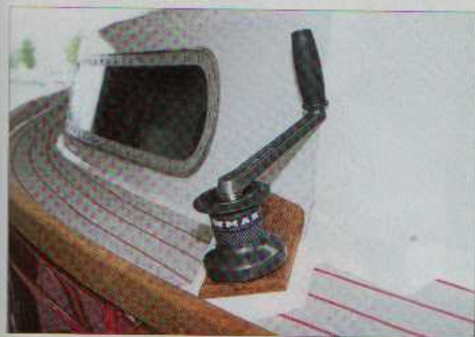
Attention à la longueur de la manivelle ! Dans ce cas, nous avons dégagé le winch au maximum vers l'extérieur pour gagner quelques centimètres afin qu'elle puisse tourner.
