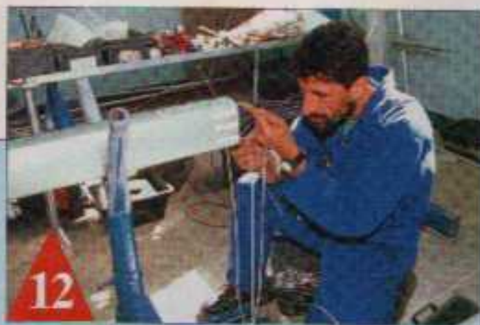
12 ...en place des messagers de drisse, on utilise également un tube PVC pour emmener chaque bout qu'il faudra ensuite identifier.
