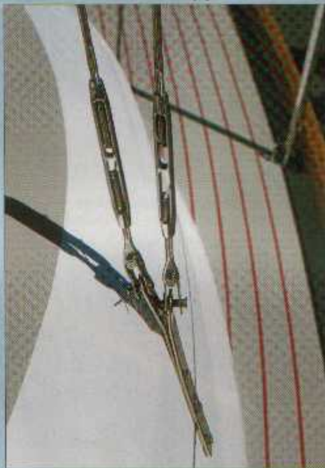
Les ridoirs à chape articulée permettent aux haubans de tirer parfaitement dans l'axe.
