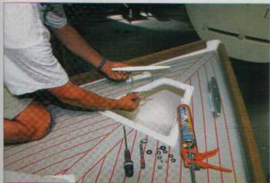
Une astuce à retenir pour l'un de nos taquets avant : sa contreplaque munie d'un anneau sert de point d'étalingleure.
