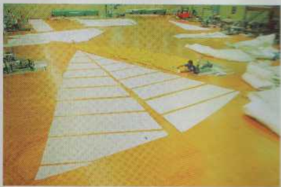
Une trentaine d'heures de travail séparent ces deux photos sur le plancher sur la voilerie du Groupe Incidences, à La Rochelle : à gauche, les vingt laizes brutes qui composent le grand-voile et le génois du Sylphe et, à droite, les mêmes, assemblées !
