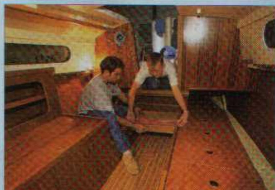
Après la pose des flancs de couchette, on s'attaquera aux innombrables petits détails qui font pourtant la différence comme une petite trappe pour isoler le dessous du cockpit (à gauche), ou encore la marche de la descente en teck massif.
