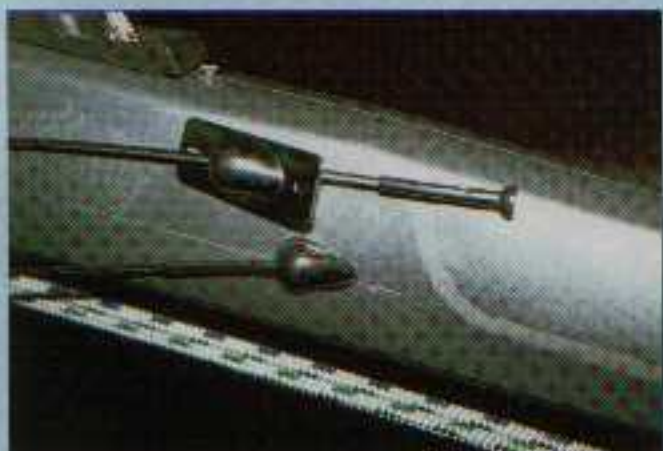
Les galhaubans et bas-haubans du Sylphe sont réalisés en câble monoton de 4 mm de diamètre, dotés d'embout à boule à coquille qui s'enfilent en biais dans leur logement.
