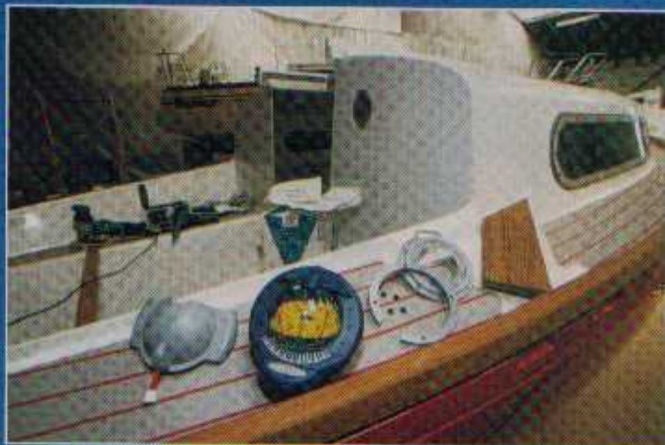
L'emplacement du compas de cloison était déterminé par la position du trou de l'ancien modèle sur le rouf.
