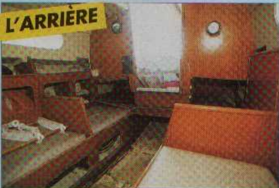
Les quatre couchettes du Sylphe (à gauche) manquaient cruellement de largeur au épaule et leur côté cellulaire n'était pas des plus joyeux ! Les parois arrière du roof en contreplaqué (à droite) recevront elles aussi un placage de 2 mm en teck.
