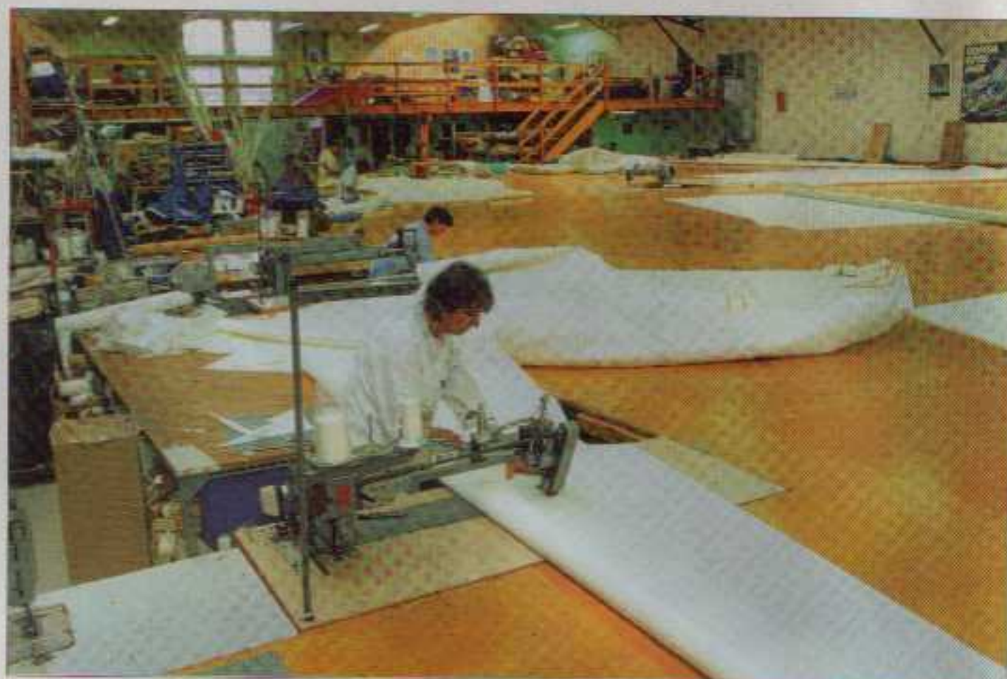
Pour le néophyte : vision déroutante d'un plancher d'une voilerie où les machines à coudre sont disposées au niveau du plancher et au bord d'une fosse pour faciliter les manipulations.
