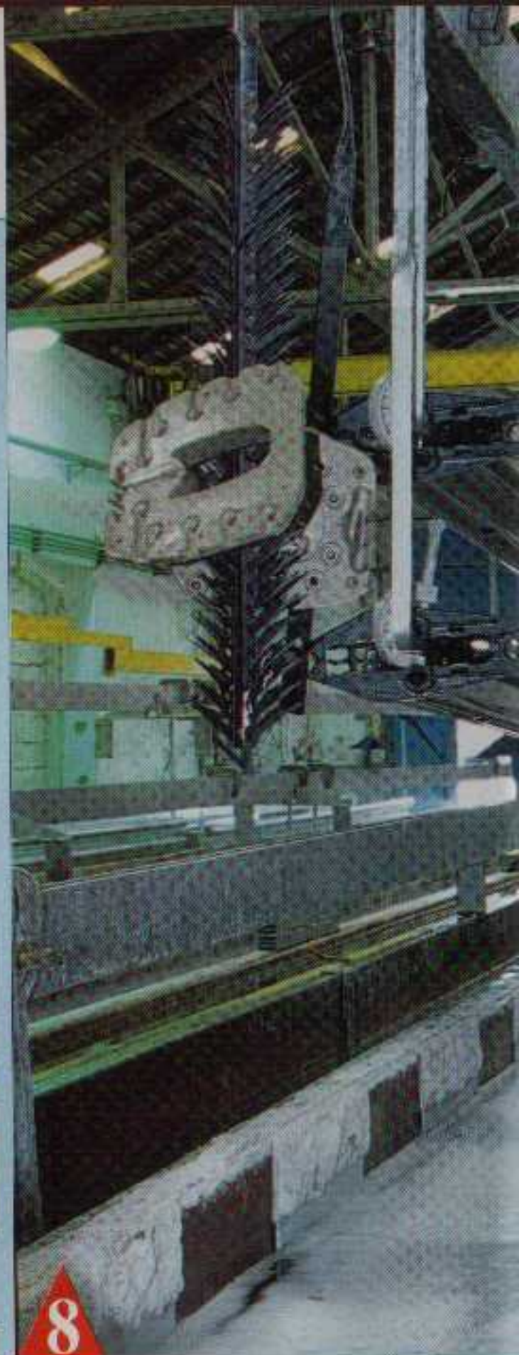
8 Pour l'anodisation qui dure trois heures, le mât est plongé dans onze bains successifs.
