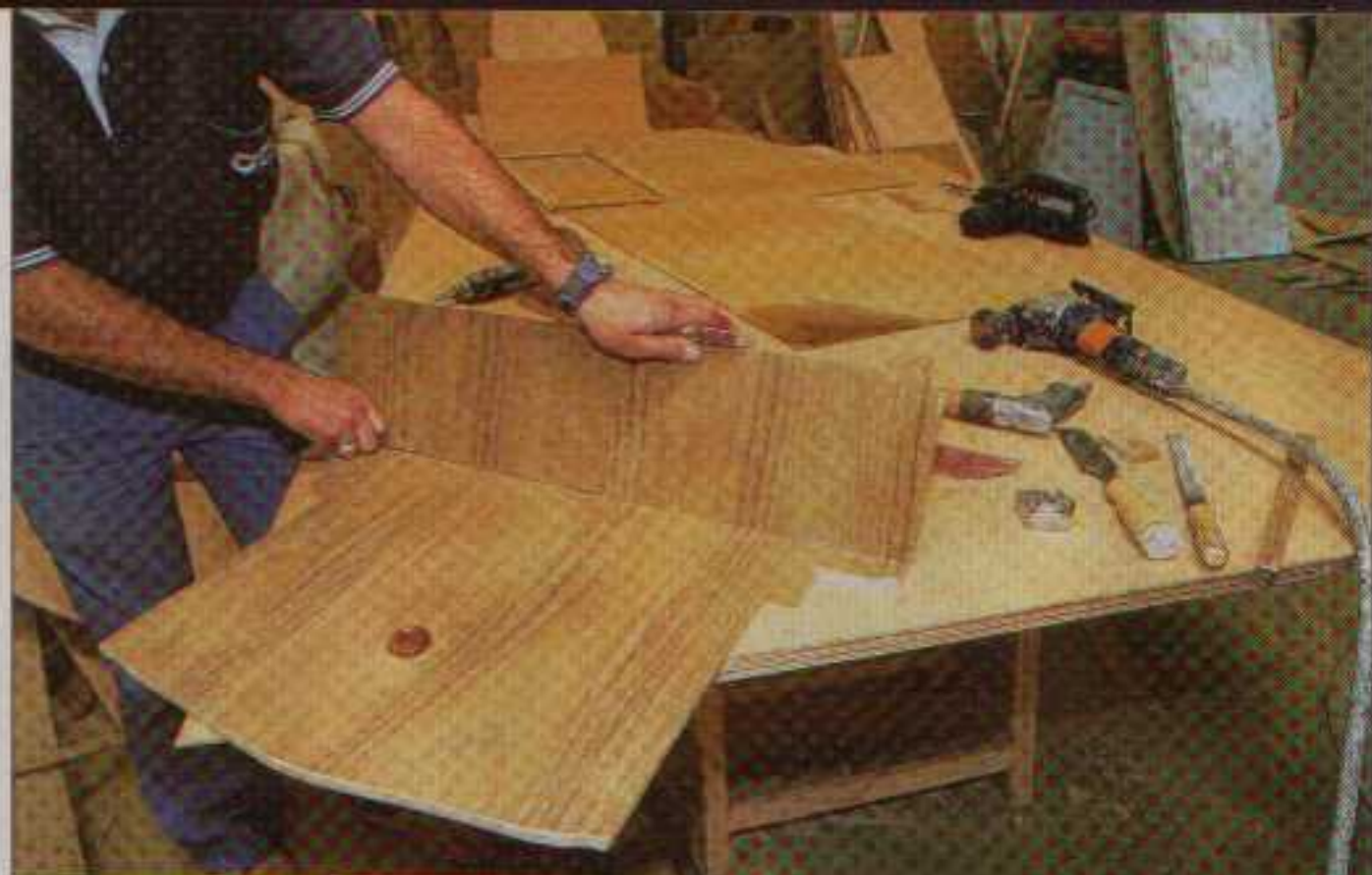
Pour la touche finale, rien ne remplace le ponçage à la cale de bois, comme ci-dessus, pour les chants de la petite porte qui viendra fermer le logement du radeau sous le cockpit.
