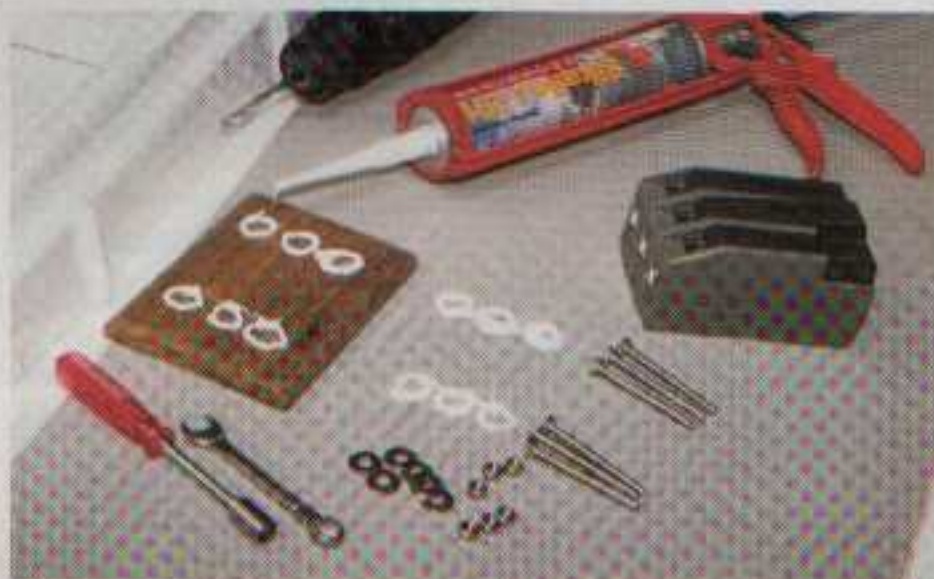
Mettre en place au fur et mesure du perçage les boulons permet de s'assurer de leur bon alignement. Ci-dessus, pour la pose des bloqueurs triples Lewmar Ocean, nous avons utilisé une cale en teck pour les surélever légèrement.
