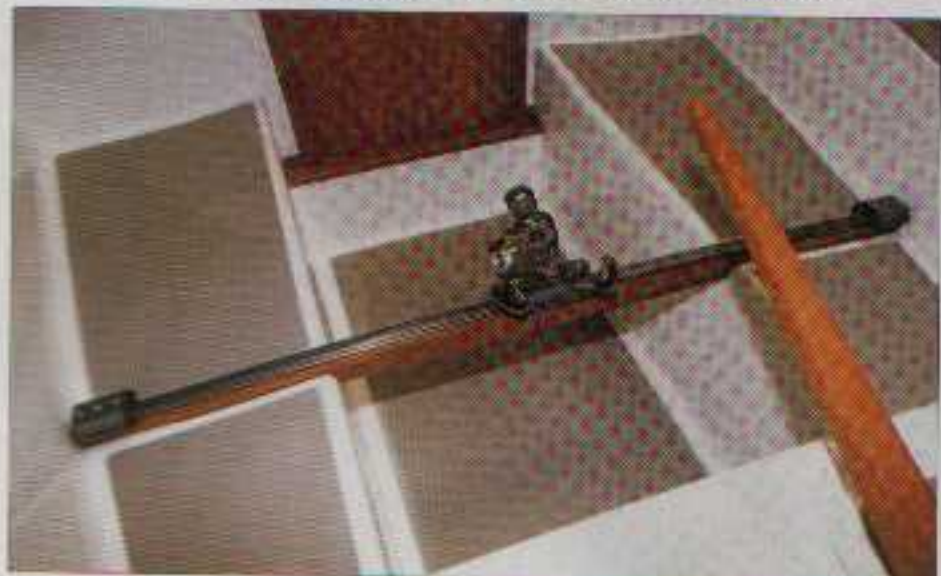
Si la barre d'écoute est positionnée sur un barrot en teck pour des raisons esthétiques, il existe aussi des profils auto-porteurs chez Lewmar qui permettraient de s'en passer.
