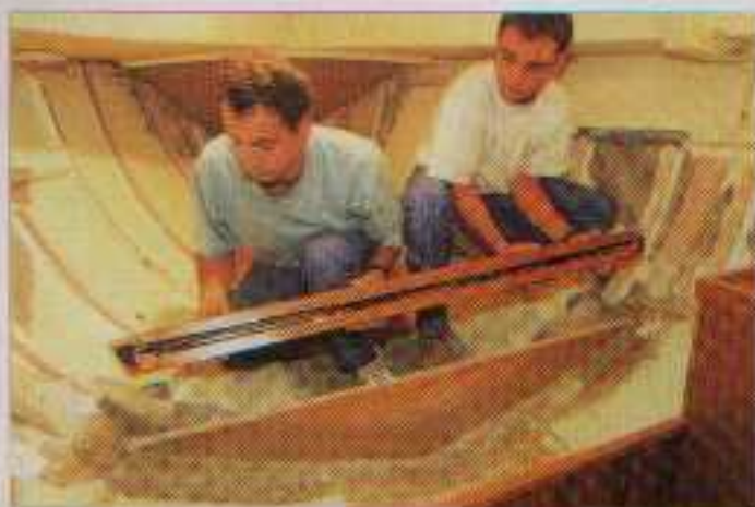
Après avoir stratifié une varangue en contreplaqué de 22 mm, nous la coifferons d'un épais massif en teck, collé au Sikaflex, qui reprendra la compression du barrot lamellé.
