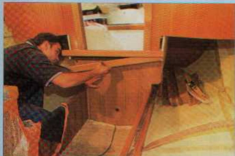
Après la pose des flancs de couchette, on s'attaquera aux innombrables petits détails qui font pourtant la différence comme une petite trappe pour isoler le dessous du cockpit (à gauche), ou encore la marche de la descente en teck massif.
