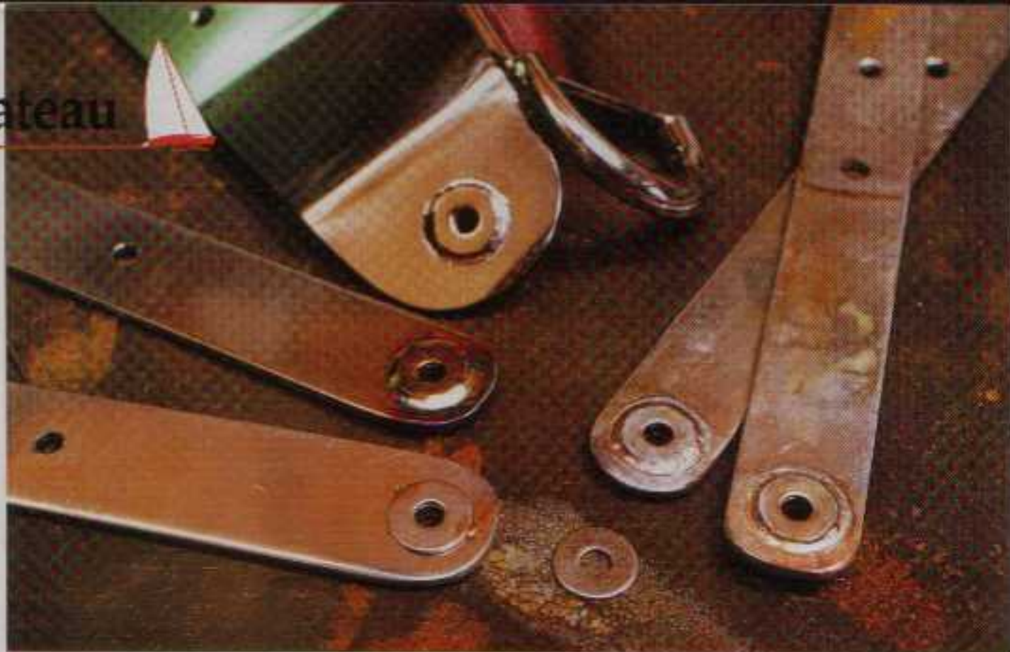
Les trous des cadènes sont renforcés par des rondelles soudées de part et d'autre de la latte afin d'éliminer les risques d'ovalisation. Notez le pointage puis le filet de soudure complet.
