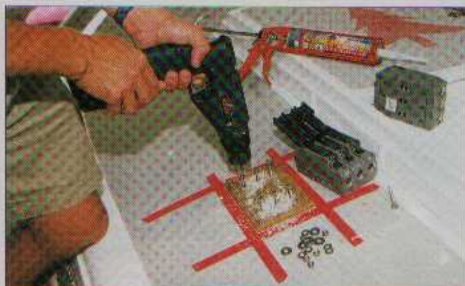
Mettre en place au fur et mesure du perçage les boulons permet de s'assurer de leur bon alignement. Ci-dessus, pour la pose des bloqueurs triples Lewmar Ocean, nous avons utilisé une cale en teck pour les surélever légèrement.
