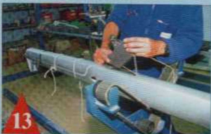
13 Avant de positionner définitivement les réas, il convient d'y faire passer les messagers.
