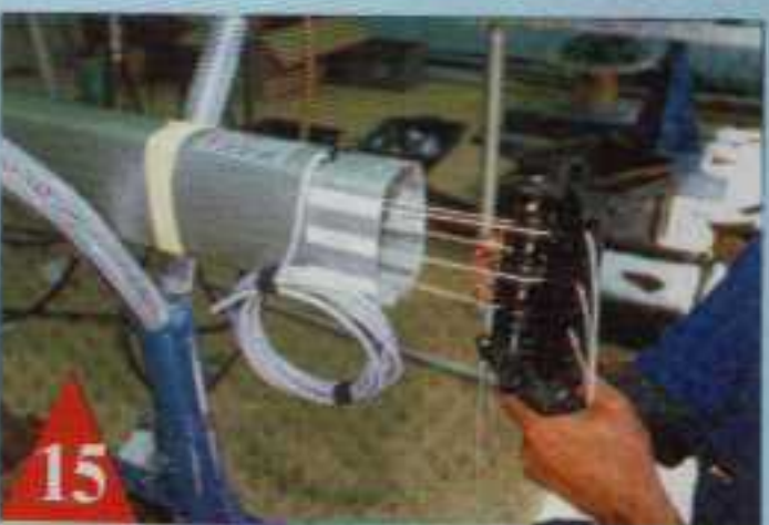
15 Vers le bas, tous les messagers sortent au pied de mât et sont renvoyés par un double...
