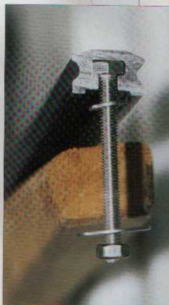
Avec le type de rail Lewmar que nous avons utilisé pour la barre d'écoute, on utilise des boulons à tête hexagonale qui sont enfilés dans le profil et qui disparaissent complètement à l'œil. De plus, ce système permet de remplacer d'anciens rails sans avoir à repercer des trous, car les boulons, en coulissant dans le profil, se positionnent à la demande.
