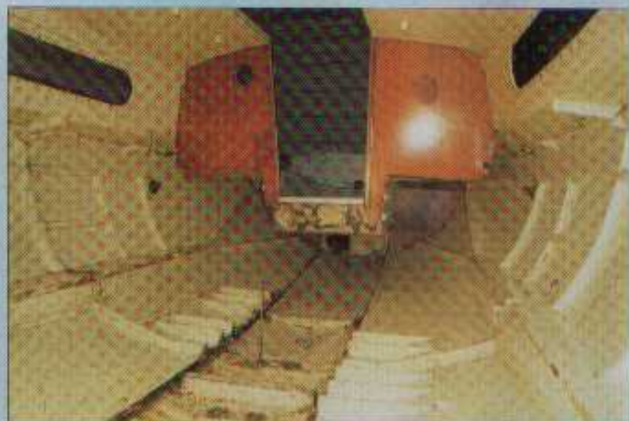
Les quatre couchettes du Sylphe (à gauche) manquaient cruellement de largeur au épaule et leur côté cellulaire n'était pas des plus joyeux ! Les parois arrière du roof en contreplaqué (à droite) recevront elles aussi un placage de 2 mm en teck.
