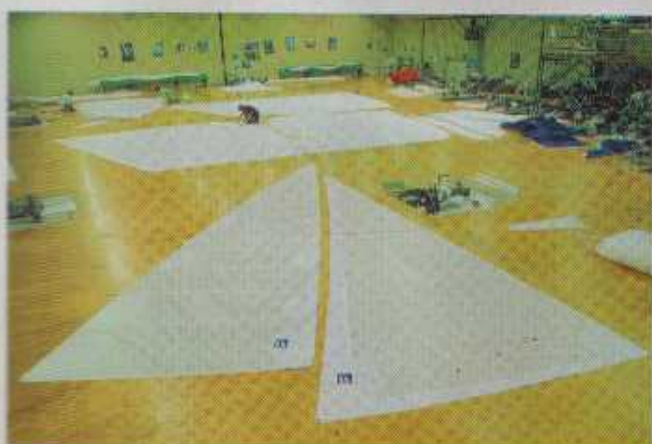
Une trentaine d'heures de travail séparent ces deux photos sur le plancher sur la voilerie du Groupe Incidences, à La Rochelle : à gauche, les vingt laizes brutes qui composent le grand-voile et le génois du Sylphe et, à droite, les mêmes, assemblées !
