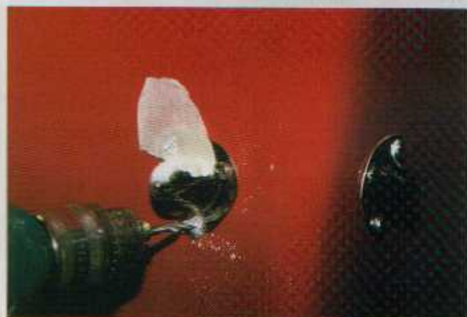
Les déflecteurs (12 F pièce !) pour les trous d'évacuation de la baille à mouillage sont fixés par trois vis dans le polyester.
