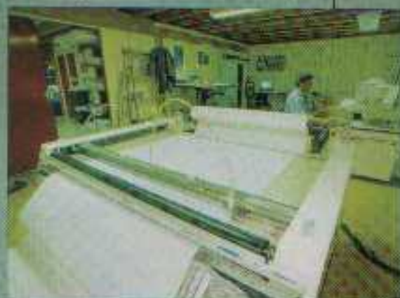
Le traçage des laizes avec le marquage des renforts est assisté par ordinateur.
