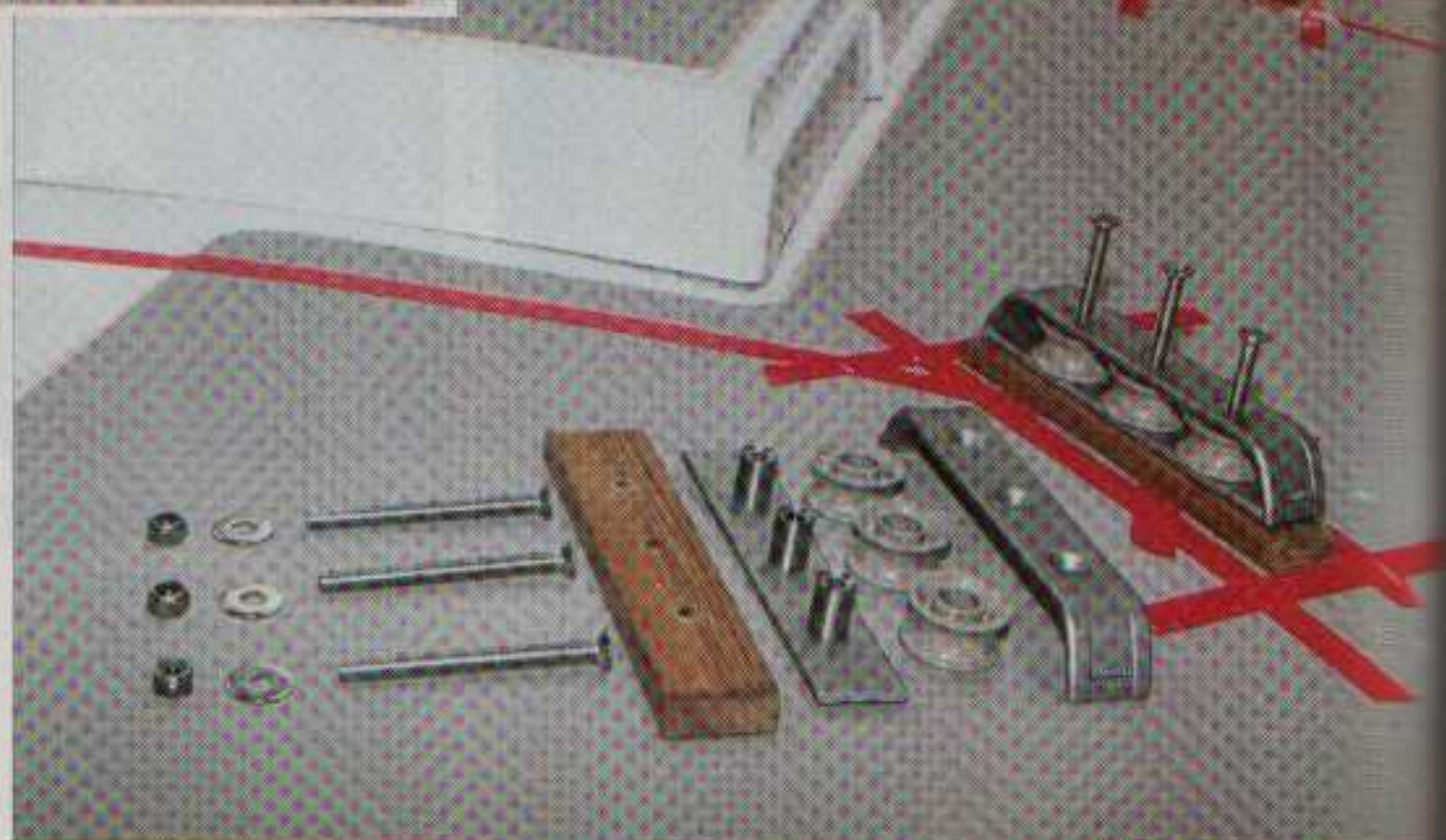
Les boîtes à réas Lewmar ont été posées sur des cales en teck qui épousent le galbe du pont.
