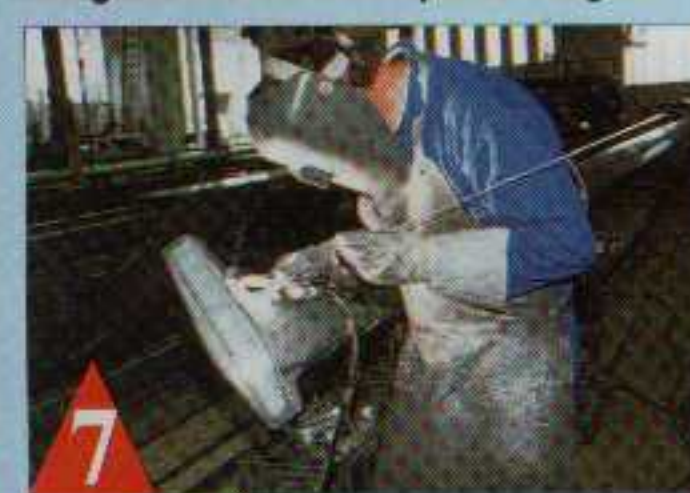
7 Les éléments rapportés par soudure (ici la tête de mât) sont posés avant l'anodisation.
