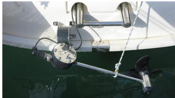
Je nach Wandstärke des Hecks sollte innenseitig in der Achterpiek der Montagebereich mit einer Versteifungsplatte verstärkt werden.
