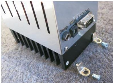
Controllerbox möglichst in der Nähe der Batterie installieren. Befestigung erfolgt mit den 4 mitgelieferten Haltefüßen. Der Kühlkörper sollte gut durchlüftet werden. Montage sollte so erfolgen, dass die Kühlrippen vertikal liegen und die entstehende Thermik für eine bessere Kühlung sorgt.
