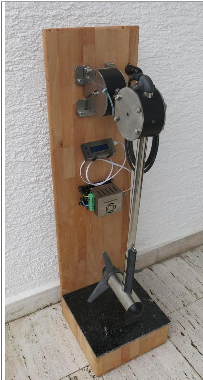
Hydrogenerator-Turbine mit ca. 2m Kabel mit wasserdichtem Stecker/Dose
