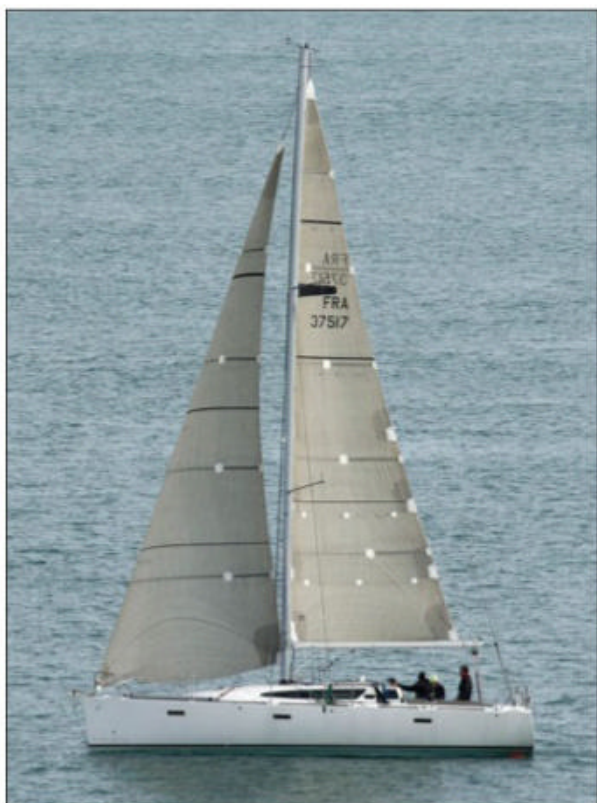
▲ Ce gréement fractionné à deux étages de barres de flèche poussantes est simple et efficace.
