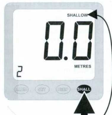
Figure 6 : Réglage d'alarme haute ou basse
