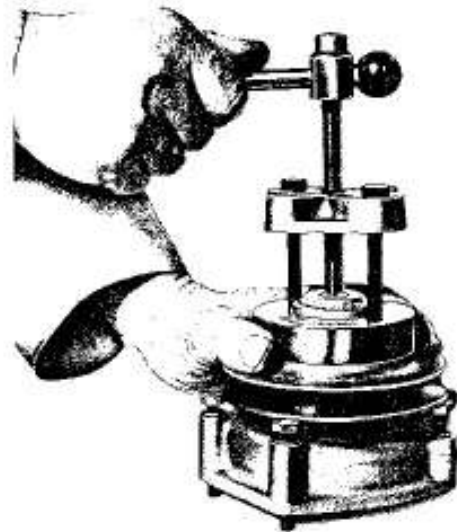
Extraction de la poulie de pompe à eau
