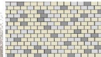
Pavés béton multiformat calepinage avec teintes nuancées en harmonie avec les enrobés
