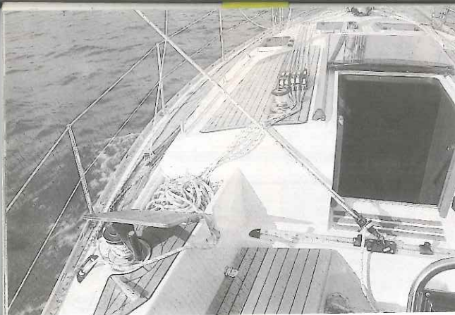
Grâce à cet astucieux coffre en haut de l'hiloire, les bouts ne traînent pas dans le cockpit.
