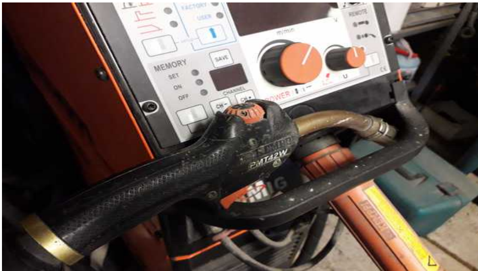
La molette de réglage de courant sur la torche.
