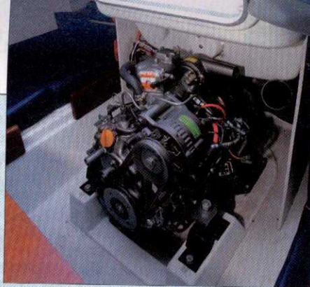
Le Yanmar de 9 ch trouve place sous la descente du Surprise et son capot sert de marche.
