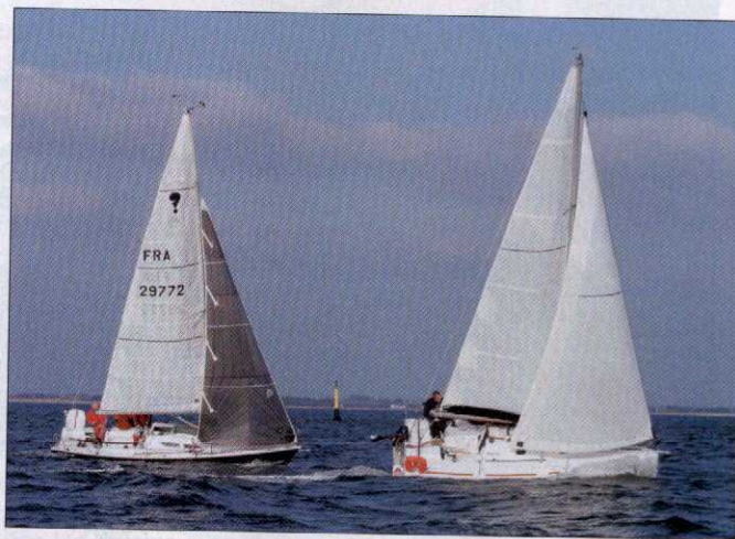
Le Surprise est gréé en 7/8 alors que le capelage du foc est plus haut sur le Yaka (9/10).
