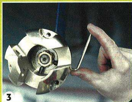
3 ▲ Il faut absolument sécuriser l'écrou avec les deux vis-pointeaux qu'on aura enduites de Loctite.
