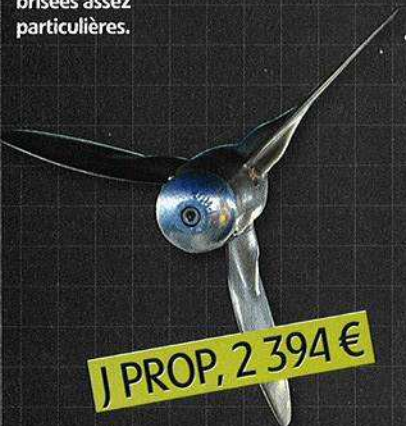
▲ Pour régler le pas, il suffit de tirer la bague vers l'arrière et de la tourner d'un ou plusieurs crans.
