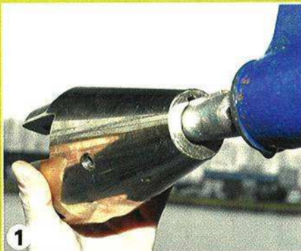
1 ▲ On engage le moyeu sur le cône de l'arbre, avec sa clavette dans l'encoche ad hoc.
