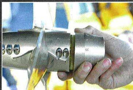
▲ Pour régler le pas, il suffit de tirer la bague vers l'arrière et de la tourner d'un ou plusieurs crans.
