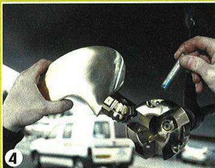
4 ▲ On passe les axes avec un peu de graisse. Gare à ne pas décaler une pale par rapport aux autres.
