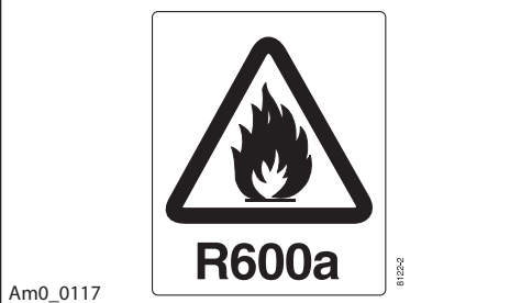
Fig. 6 : étiquette sur le compresseur pour le R600a
