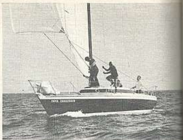
Aux allures portantes, le MK III profite d'une grande longueur de flottaison. Les hiloires de roof sont un peu glissantes pour la manœuvre.
