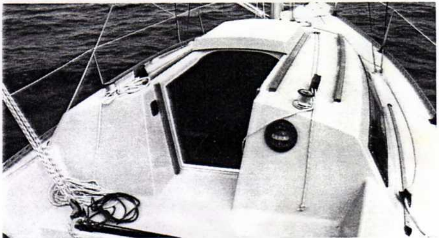
L'étanchéité du capot de descente n'est pas assurée sur l'avant. Un accastillage complet et de bonne qualité avec retours au cockpit.
