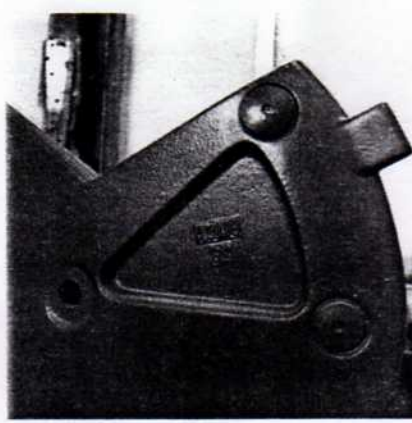
Des pastilles hémisphériques permettent d'ajuster le calage de la quille.
