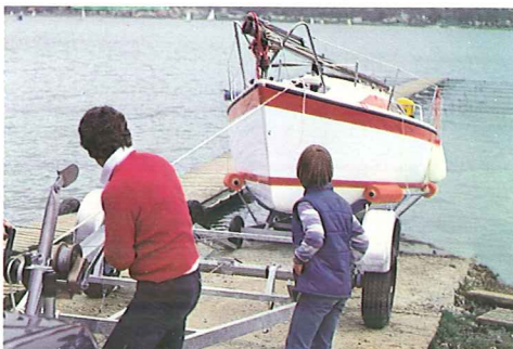
... mit Hilfe einer elektrischen oder mechanischen Seilwinde das Boot auf den Trailer gezogen ...
