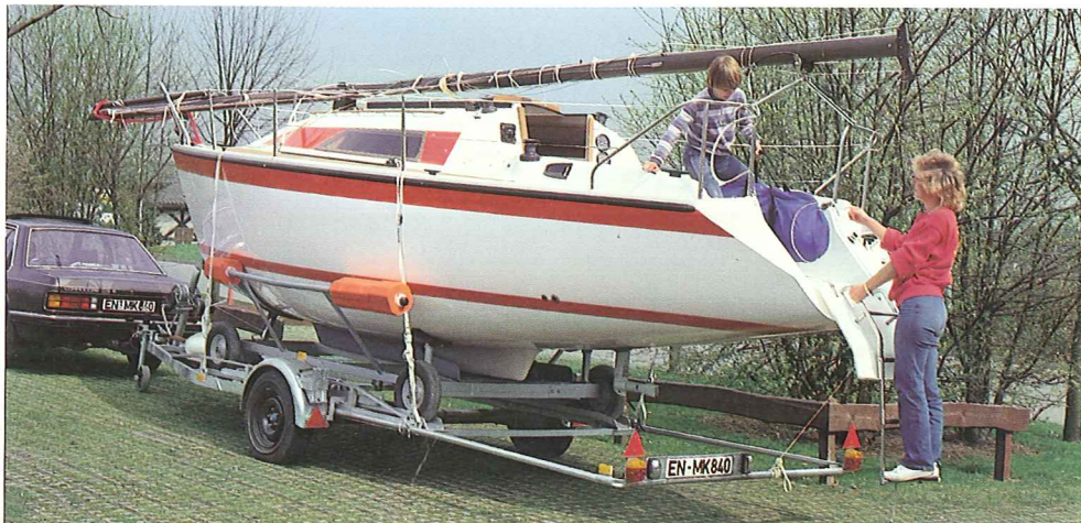
Aufgrund der niedrigen Transporthöhe gelangt man über die herausklappbare Heckleiter** im Spiegel bequem ins Schiff.
