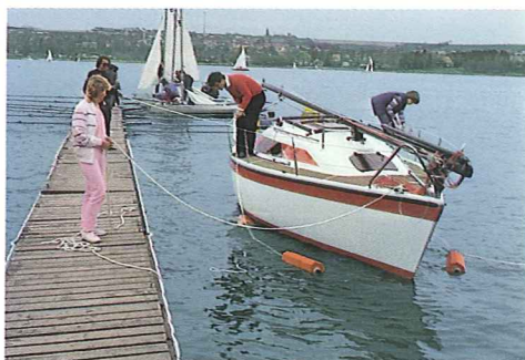
Der schwimmbare Slippwagen wird unter das Schiff gezogen und befestigt ...
