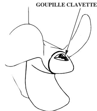
Une goupille de cisaillement est utilisée pour protéger l'hélice ainsi que le mécanisme d'entraînement contre tout dommage si l'hélice heurte un écueil.
