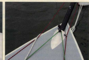
L'étrave du Hamac (1) est équipée : balcon, chaumards, taquets et une vraie baille à mouillage. Celle du Skellig (2) ne reçoit que la chaîne : l'ancre se fixe sur le pont. A bord du Speed Feet (3), l'anneau de remorquage sur l'étrave sert à l'amarrage.
