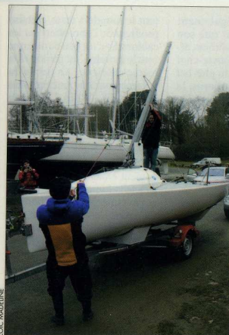
Le mât carbone du Speed Feet est léger (8 kg), c'est toujours plus facile pour le monter sur sa rotule.
