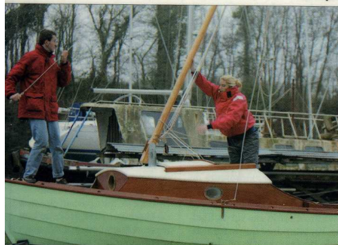
Deux bons points pour le mâtage du Béniguet : des jumelles hautes et un mât court grâce au gréement aurique.
