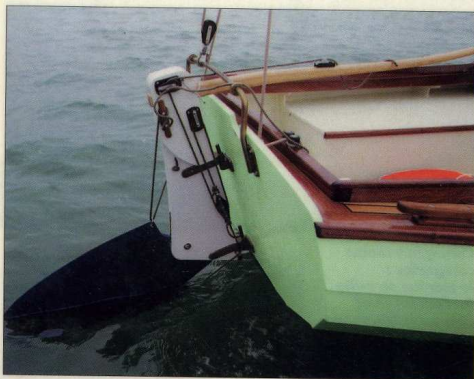
La pelle immergée en contreplaqué est articulée et l'ensemble se manie sans difficulté depuis la barre franche grâce à un système de palan installé sur le Béniguet.
