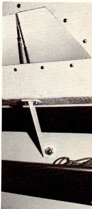
L'effort des haubans est repris par ces cadènes intérieures. L'écrou borgne inférieur masque la bride de fixation du boulon de béquilles. ▶
