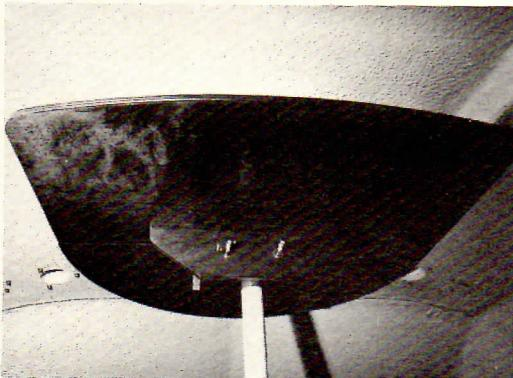
La table se bloque en position par serrage d'une mâchoire de bois autour de l'épontille. Se rangeant contre le roof, elle convient très confortablement pour quatre personnes. ▶
