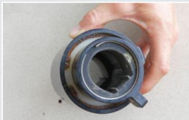
▲ L'émerillon d'enrouleur de génois est une pièce sensible à la corrosion. A surveiller!
