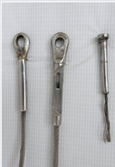
▲ Embout mal serti, détournage, fissure de l'œil nécessitent un changement immédiat.
