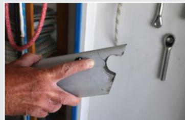
▲ La liaison barre de flèche-mât subit de l'usure mécanique. Ne pas trop tendre les D2.
