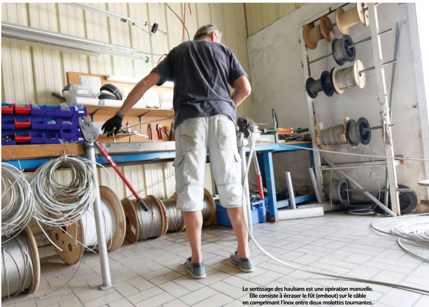
Le sertissage des haubans est une opération manuelle. Elle consiste à écraser le fût (embout) sur le câble en comprimant l'inox entre deux molettes tournantes.
